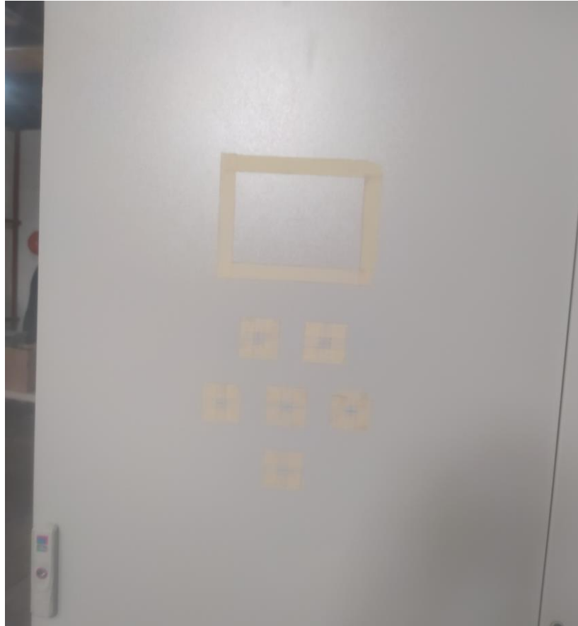
Fig. 43 Guía para corte y perforación de botonera y HMI.
