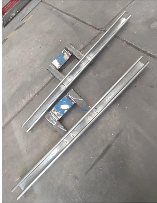
Fig. 64 Unión de elementos para base por soldadura.
