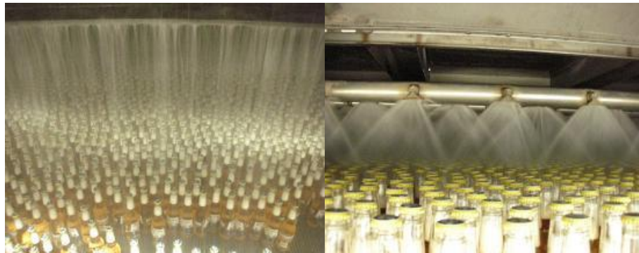
Figura 2.45 Espreado de botellas Fuente: Compañía cervecera del Trópico, 2017
