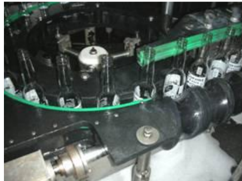
Figura 2.34 Entrada de botellas vacías a llenadora Fuente: Compañía cervecera del Trópico, 2017
