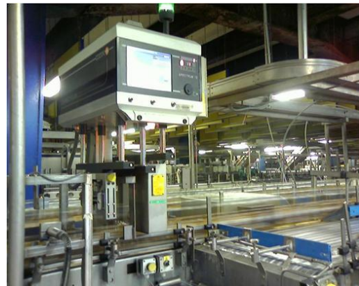
Figura 2.29 Inspector de tapa Fuente: Compañía cervecera del Trópico, 2015
