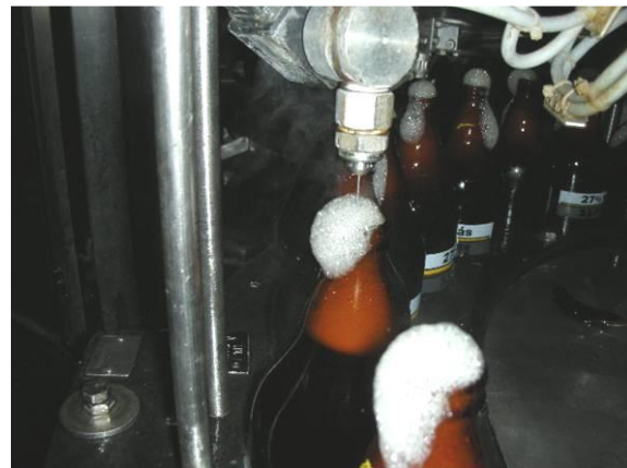
Figura 2.42 Aplicación del sistema Jetter Fuente: Compañía cervecera del Trópico, 2017
