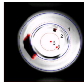
Figura 2.26 Zona de inspección de pared interna Fuente: Compañía cervecera del Trópico, 2015
