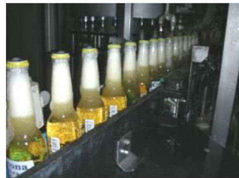
Figura 2.37 Salida de botellas llenas Fuente: Compañía cervecera del Trópico, 2017
