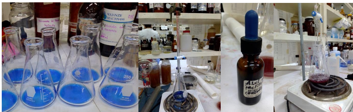
Figura 20 Titulación para obtener resultados de azúcares reductores directos.
