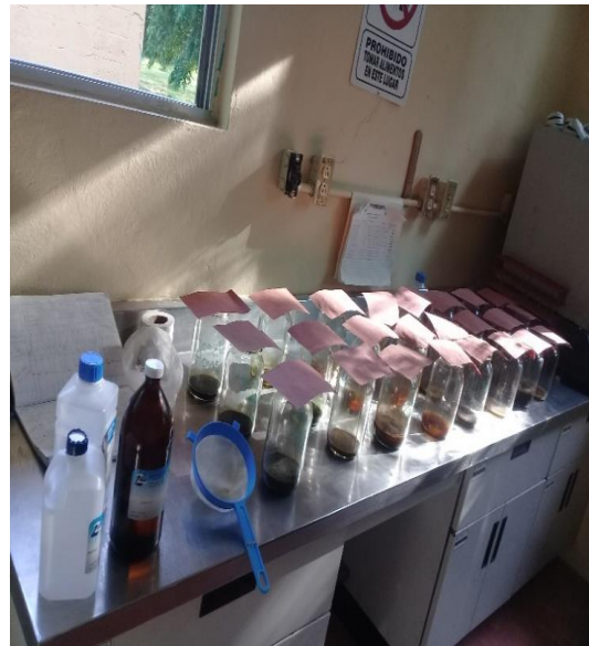
Figura 24. Decantación con tres solventes, agua destilada, alcohol etílico y hexano.
