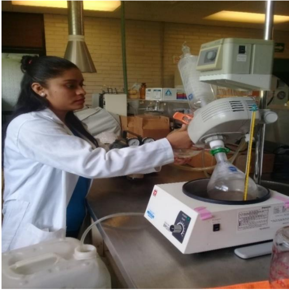
Figura 25. Extracción de metabolitos secundarios, con la máquina de rota vapor.
