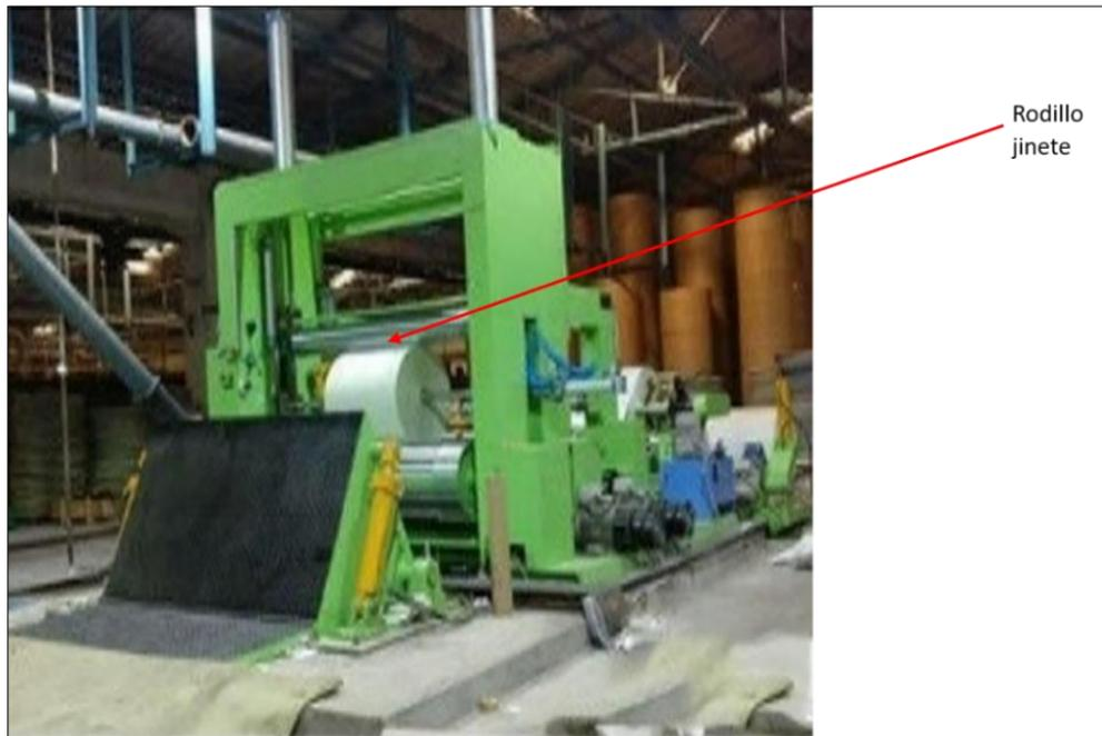
Figura.2.6 Máquina Bobinadora de Rollos de Papel.
