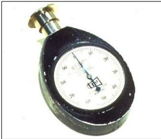
Figura.2.20 Medidor de Dureza, Aguja Smith.
