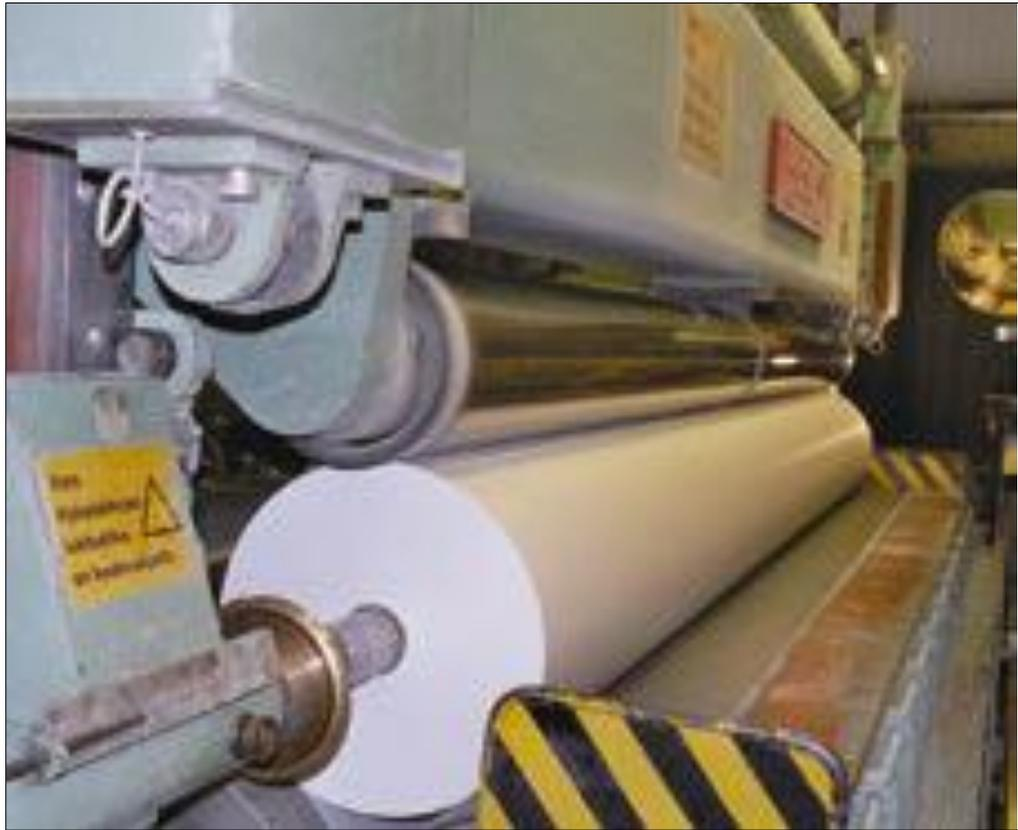
Figura.2.38 Imagen de Rodillo Jinete Presionando un Rollo.
