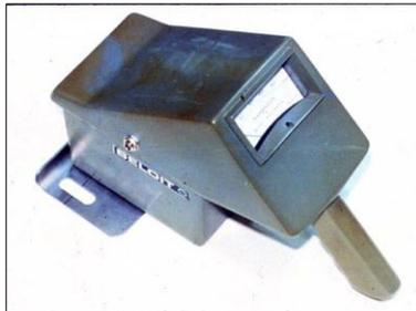
Figura.2.18 Medidor de Dureza de Rollos, Rhometer.
