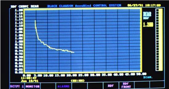
Figura.2.21 Curva de Densidad del Rollo AccuWind.
