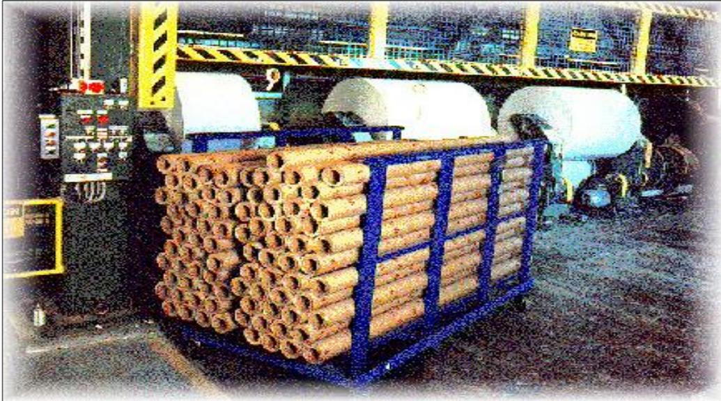
Figura.2.11 Centros de Cartón en el Embobinado de Rollos.
