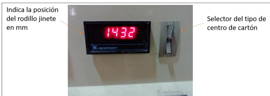
Figura.4.15 Display Posición del Jinete y Selector de Centros.
