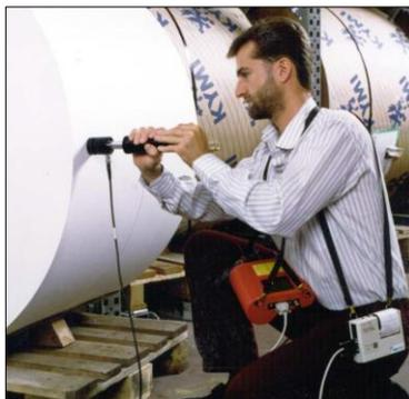
Figura.2.19 Medidor de la Dureza en Rollos, PARO tester.
