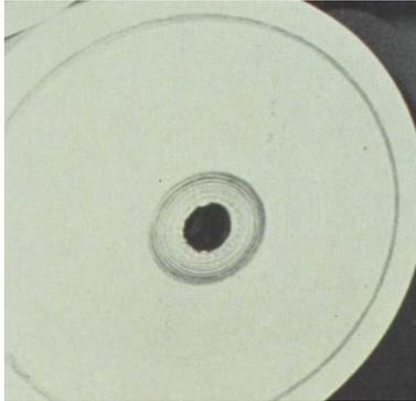
Figura.2.22 Muestra de Rollo con Mal Inicio.
