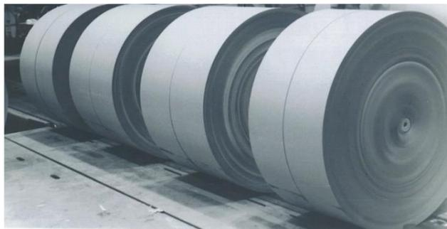
Figura.2.27 Rollos con Anillos de Corte y Mal Embobinado.
