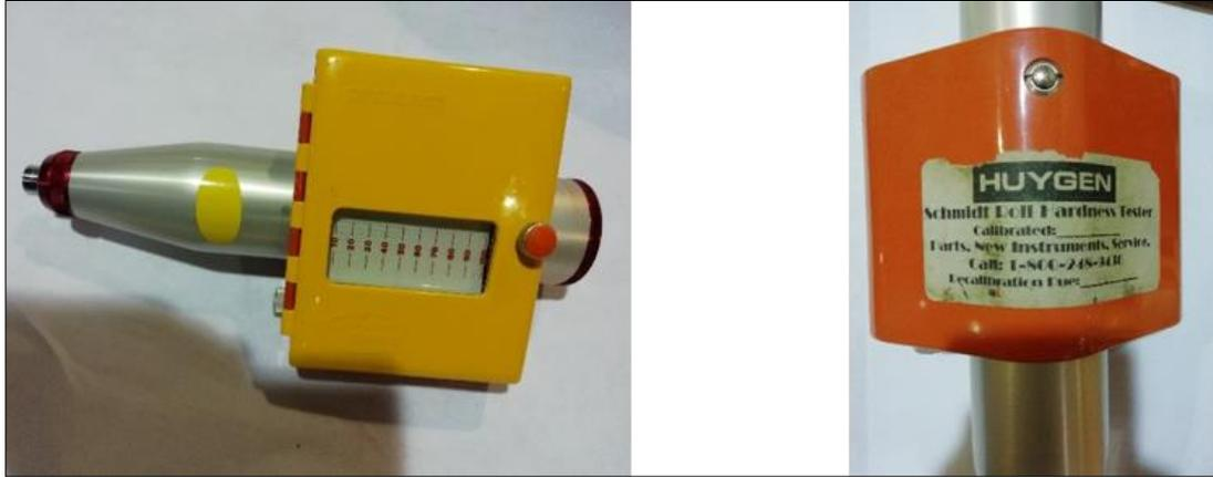
Figura.4.38 Medidor de Dureza Superficial de Rollos.
