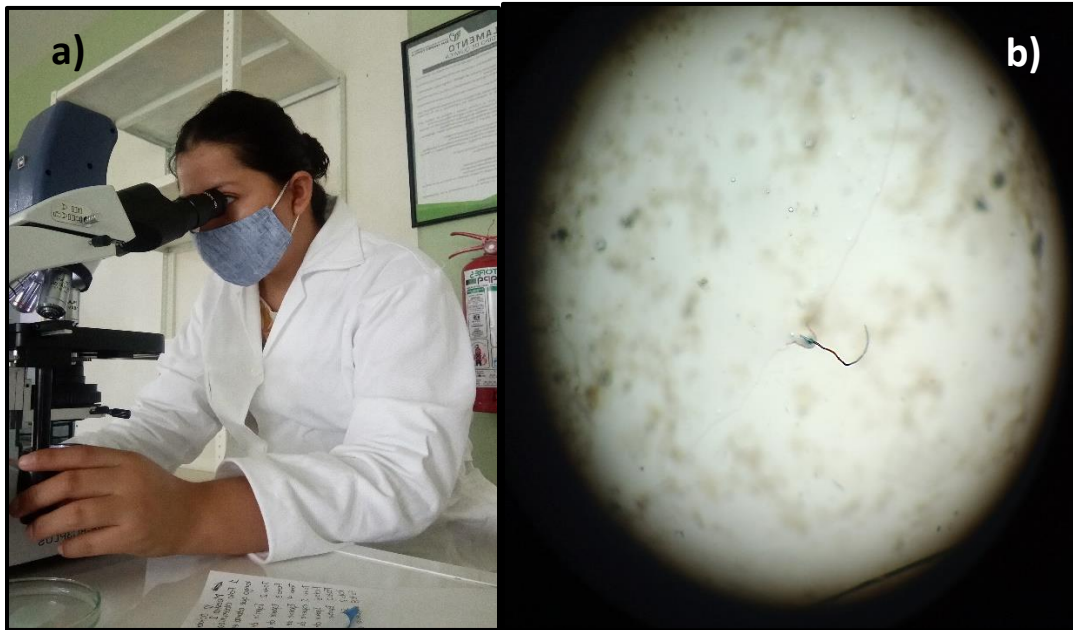
Fig. 66 a) observación de la muestra con microscopio óptico, b) fibra encontrada en muestra. Fuente: Archivo personal.
