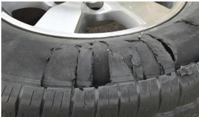
Fig. 3 Fractura de la estructura plástica debido a un esfuerzo mecánico
