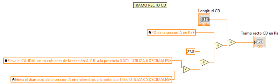
Figura 3.43: Calculo en el diagrama de bloques del tramo recto CD
