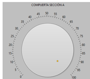
Figura 3.13: Representación de una compuerta por medio de un knob en el panel frontal
