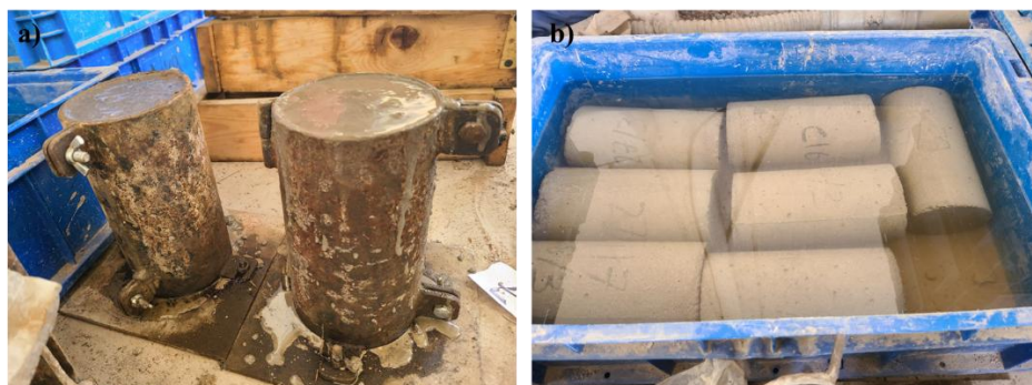
Figura 5.4. Elaboración (a) y curado (b) de los especímenes utilizados para medir la penetración de Cl^- y la carbonatación.
