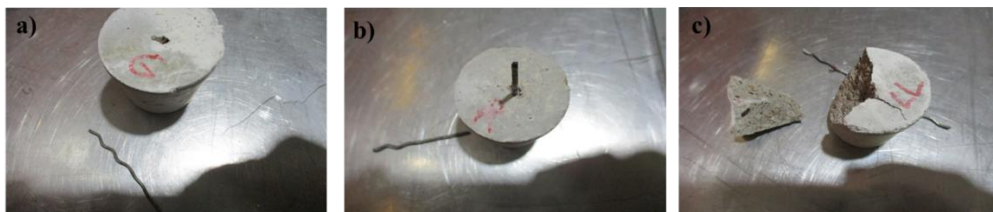
Figura 3.6. Diferentes modos de fallo observados durante pruebas de extracción.
