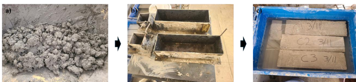
Figura 4.1. Elaboración y curado de las probetas de concreto, a) mezcla de materiales, b) moldes para darles forma y c) probetas sumergidas en agua de curado.
