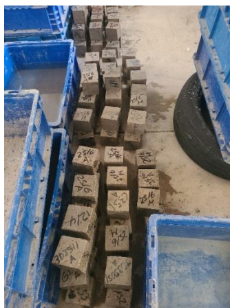
Figura 5.5. Especímenes de compresión elaborados y cumplida la etapa de curado.
