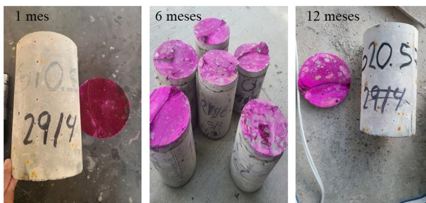
Figura 5.9. Evolución temporal de la penetración de la carbonatación en el concreto determinada mediante el método colorimétrico con fenolftaleína.
