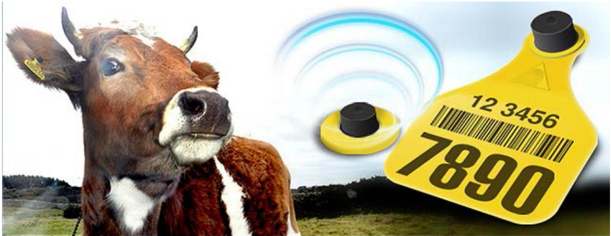
Figura 8. Identificador bovino con tecnología RFID
