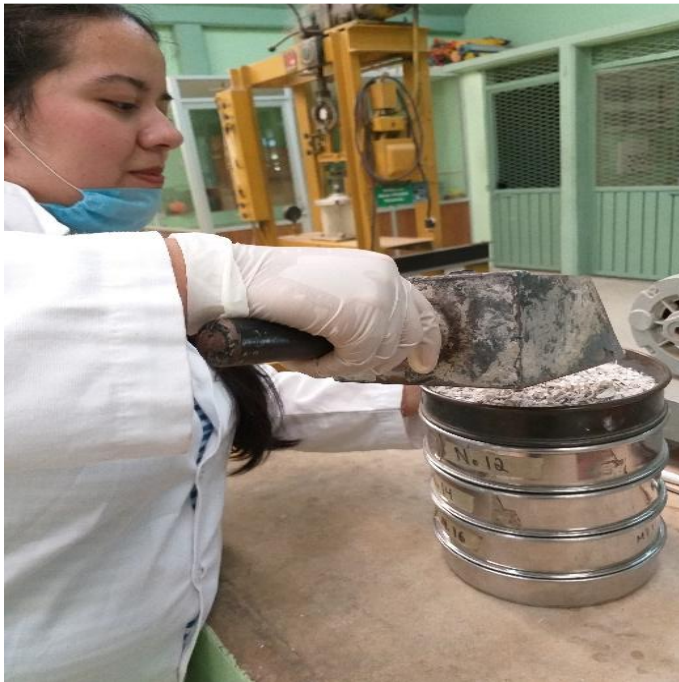
Figura 5. Colocación de concha de ostión trituradas en mallas de cribado 8, 12, 14 y 16
