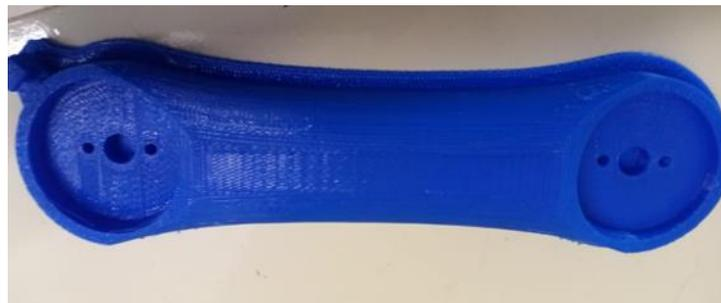
*Figura 77. Robot Arm: Arm 01 fabricada en PLA.*
