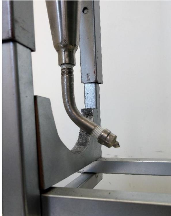
*Figura 11. Vista de la boquilla y punta extrusora del extrusor empleado para validar robot cartesiano.*
