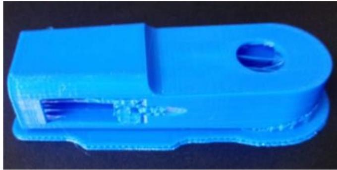
*Figura 78. Robot Arm: Arm 02 fabricada en PLA.*
