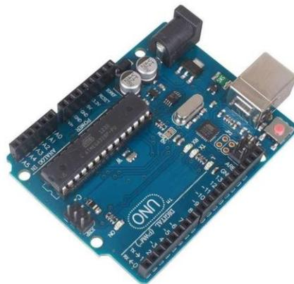
*Figura 19. Arduino UNO R3: microcontrolador ATmega328 (fuente: electrocrea.com).*
