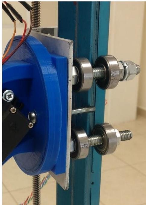
*Figura 91. Slider del eje y vista lateral.*
