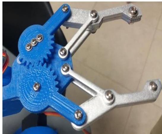
*Figura 79. Robot Arm: pinza angular fabricada en PLA y gripper de aluminio.*
