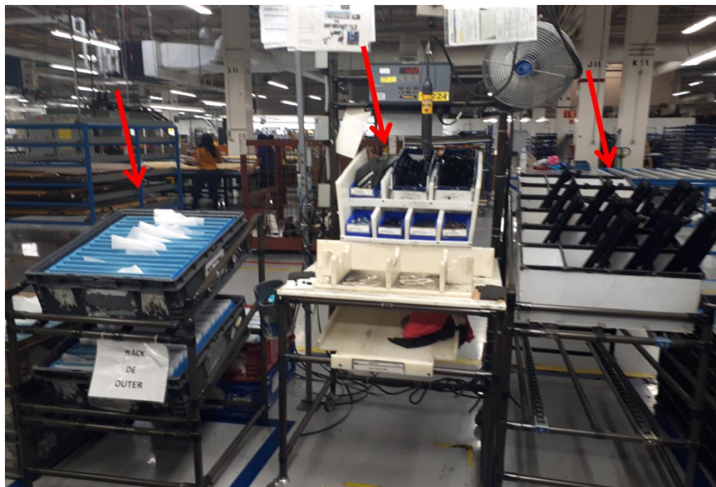
Figura 31.-Presentaciones de partes (3) modificadas para mejor facilidad de manejo para el operador
