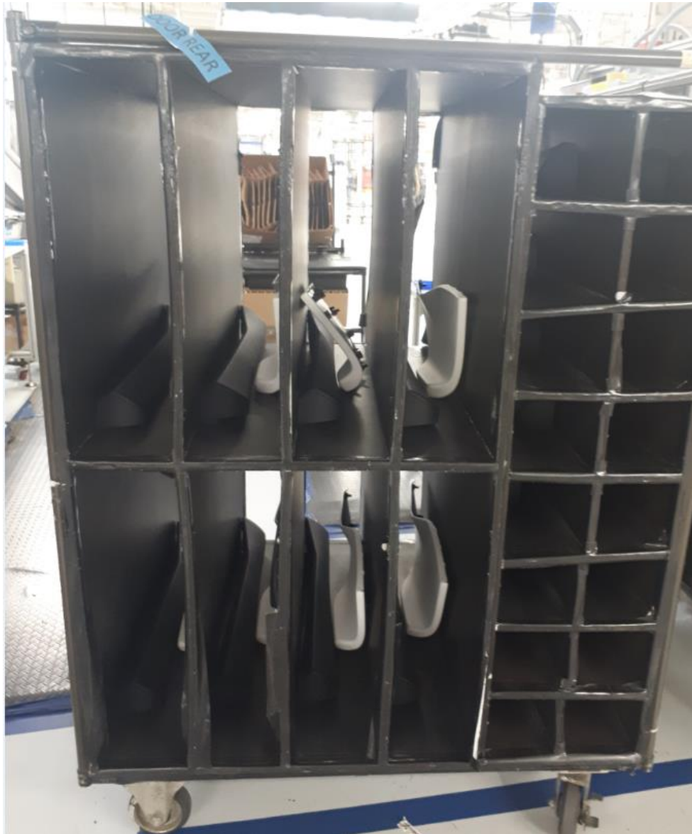
Figura 27.-Uso incorrecto de los carritos de Tesla Final Door
