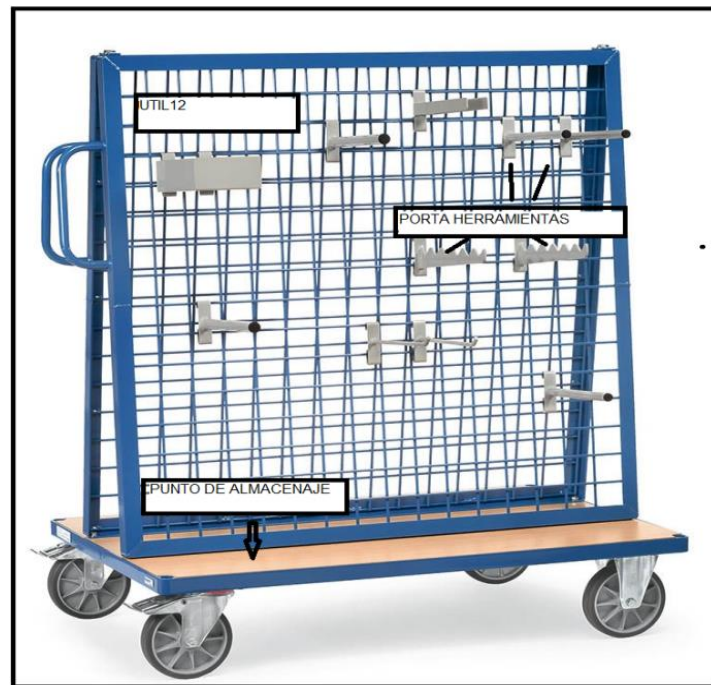
Figura 27 - Colocación de útiles para el cambio de máquina.
