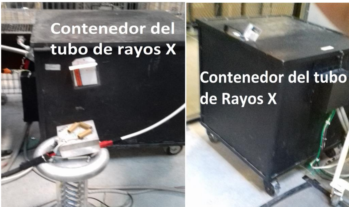
Figura 81 - Instalación del tubo de 80kw dentro de la estación de pruebas 045.
