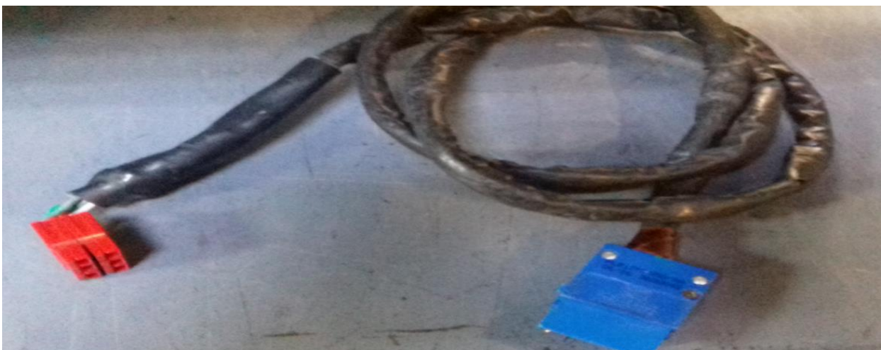
Figura 72 - Cable de comunicación del tubo de rayos X y la unidad con conectores Anderson.
