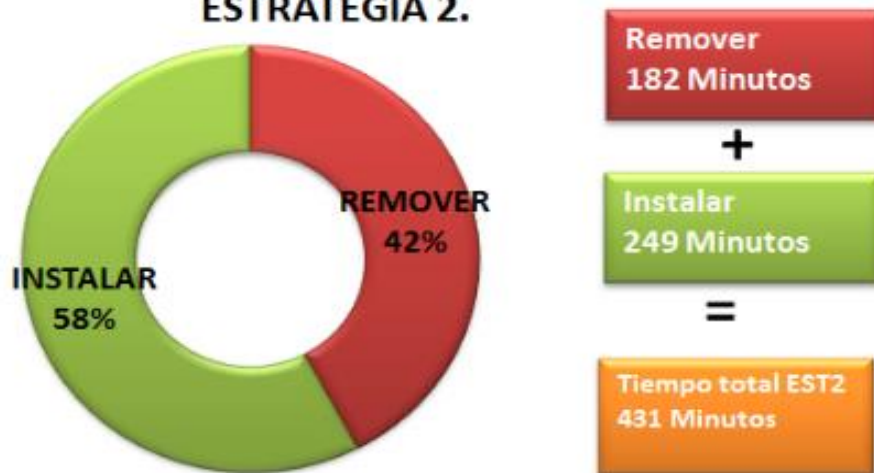
Figura 88 - Gráfica de instalar y remover durante el cambio de modelo en la estrategia 2.
