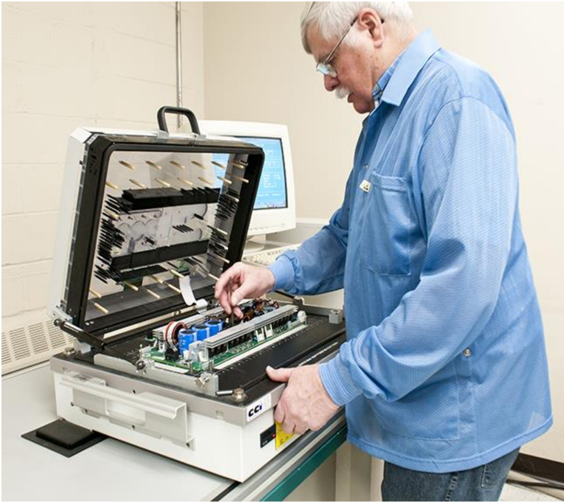
Figura 15 - Validación de un PCB en la estación de In – circuit.
