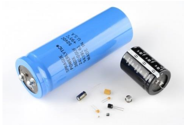
Figura 2 - Tipos de capacitores.
