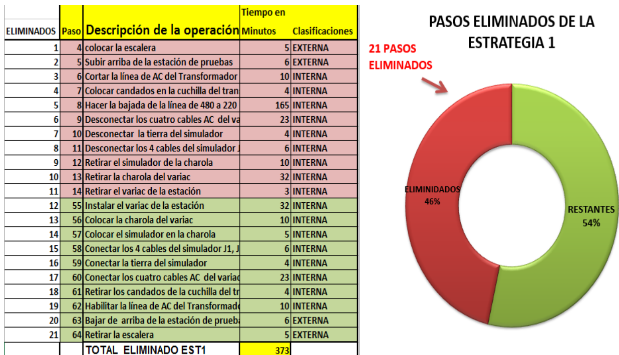
Figura 58 - Pasos eliminados del cambio de modelo de la estrategia 1.
