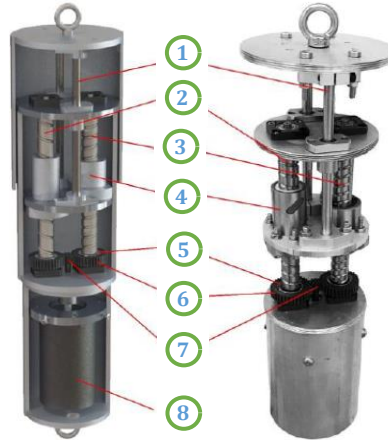
Figura 2.8: Amortiguador regenerativo electromecánico basado en doble transmisión de tornillo-bola; (1) vástago del amortiguador, (2) tornillo izquierdo, (3) tornillo derecho, (4) tuerca del tornillo, (5) embrague unidireccional, (6) engrane, (7) piñón, (8) generador eléctrico. (imagen adaptada de la Ref. [70]).
