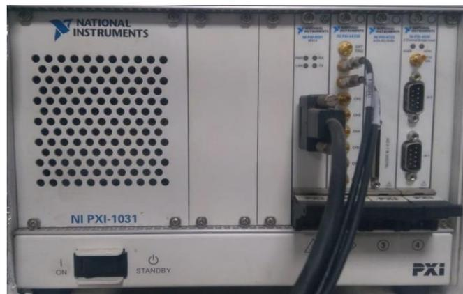
**Figura 32. Adquisidor de datos NI PXI 1031.**
