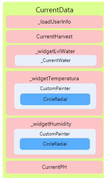
Figura 3-29. Estructura de widgets para mostrar la información de los sensores.
