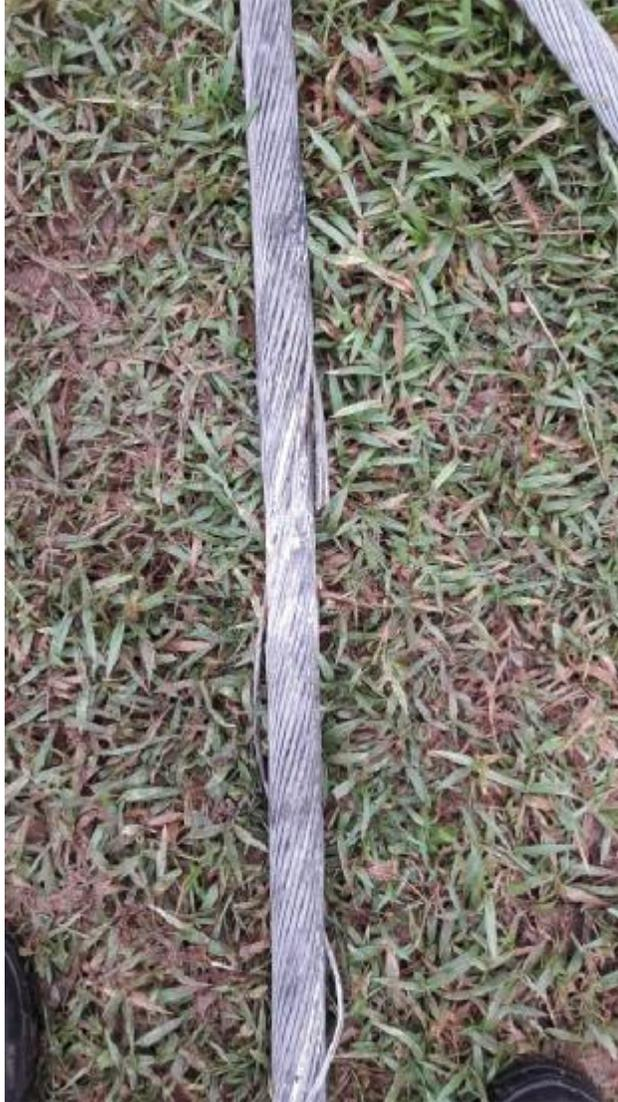
*Ilustración 57 Testigo Descarga atmosférica sobre conductor*
