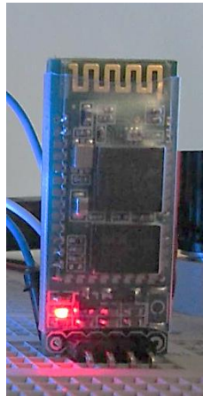
Figura 4.16 Led indicador de vinculación del módulo Bluetooth
