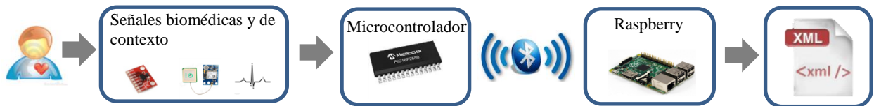
Figura 4.14 Diagrama del módulo de razonamiento
