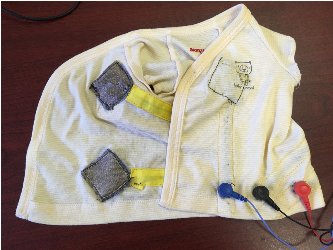
Figura 4.4: Implementación final de dispositivo de medición vestible para adquisición de señales cardíacas neonatales.
