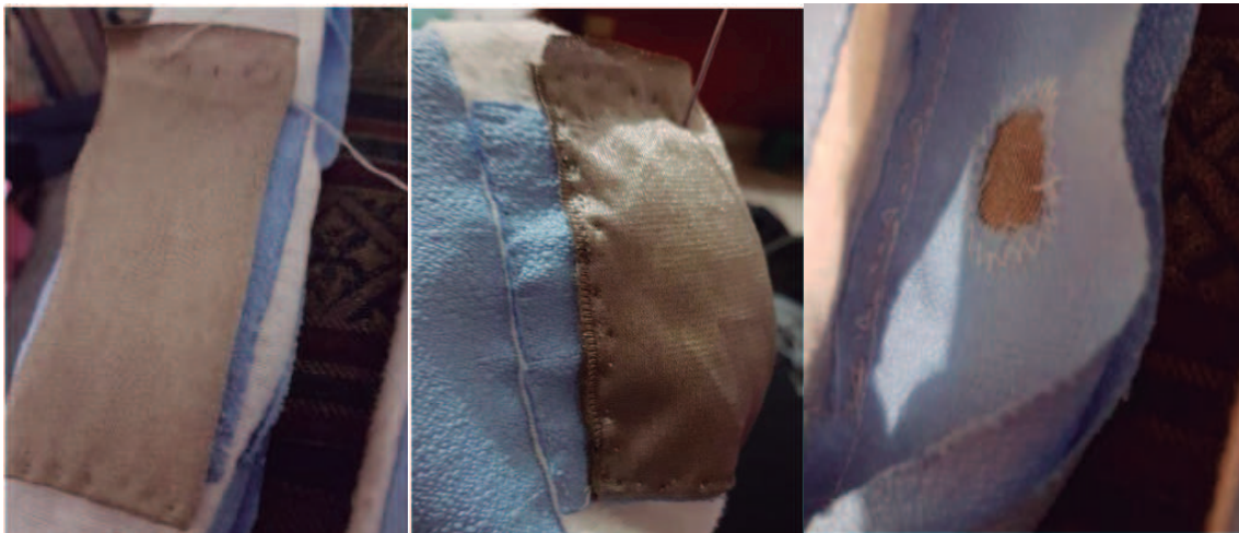
Figura 4.3: Implementación de electrodo seco para adquisición de señales cardíacas.
