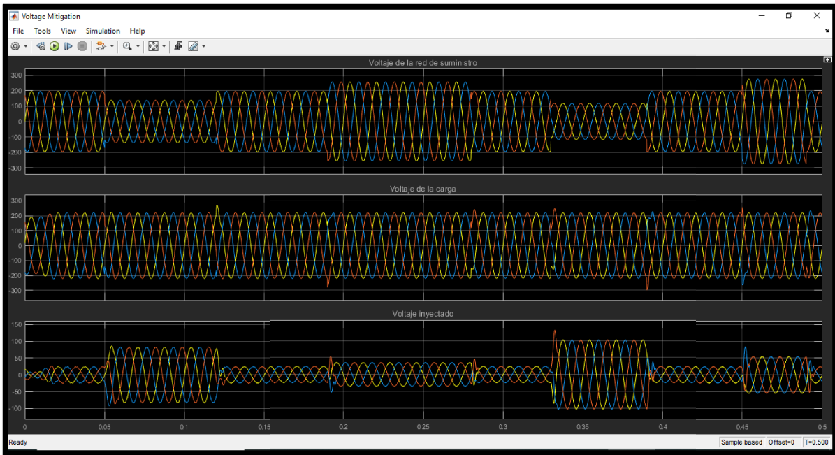
Figura 5.8 Comparación del voltaje de suministro, voltaje en la carga y señal de conmutación
