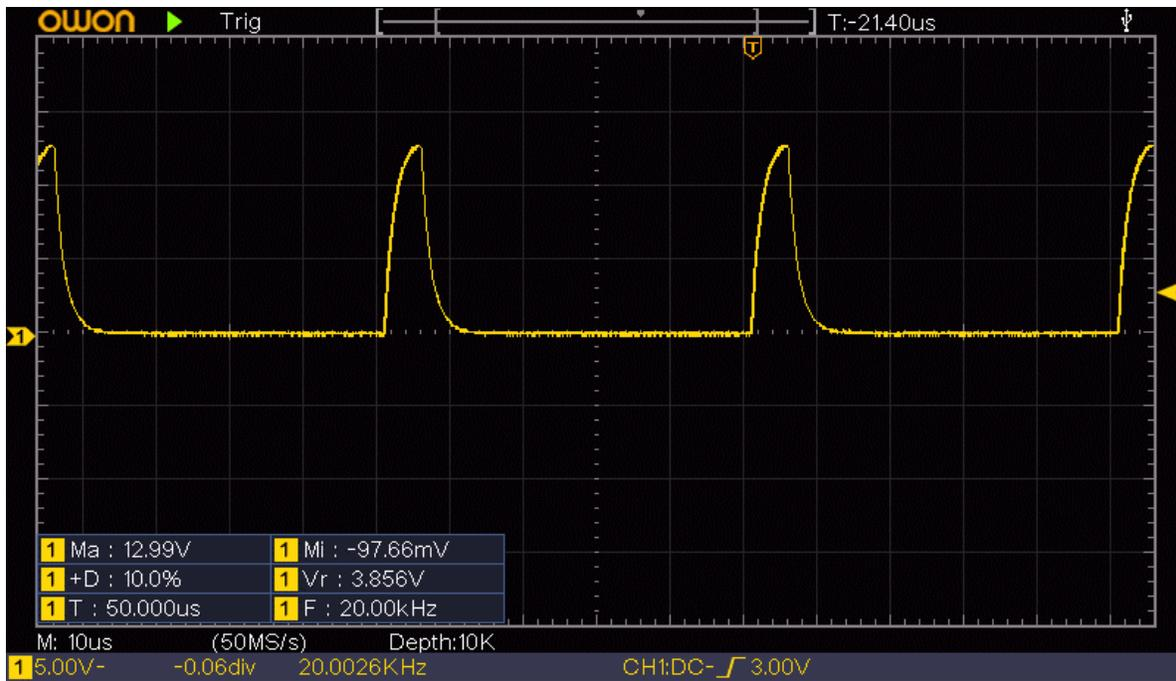
Figura 4.16. PWM salida del controlador HCPL-3120 (10 %).
