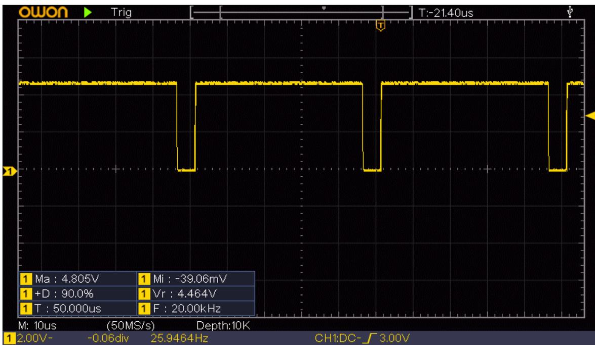
Figura 4.19. PWM salida del Arduino (90 %).
