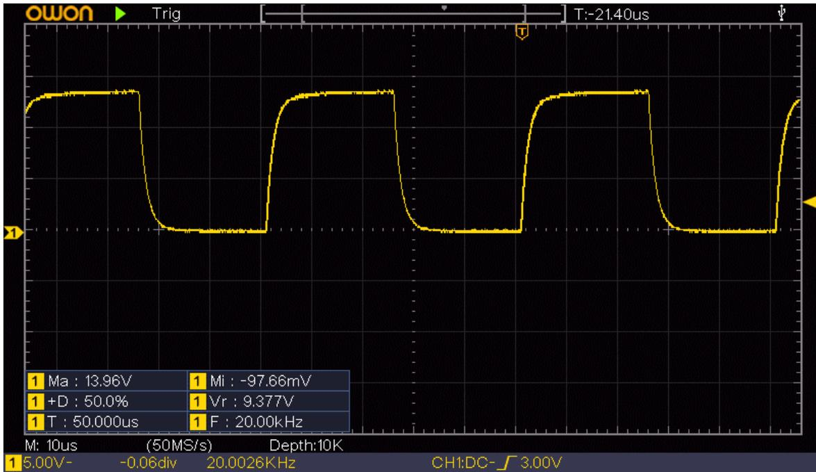
Figura 4.18. PWM salida del controlador HCPL-3120 (50 %).
