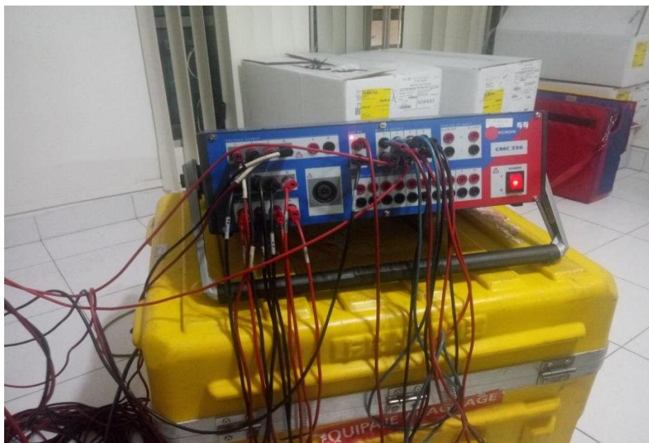
Figura 4. 4.- Equipo de pruebas OMICRON
