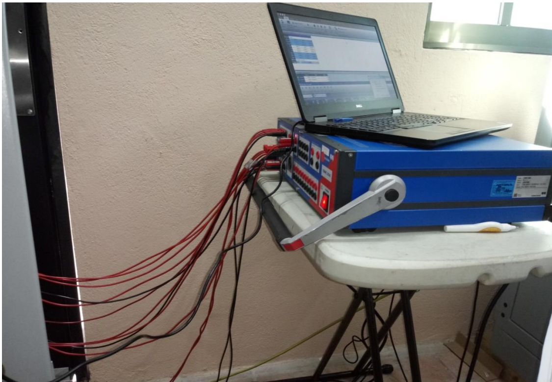
Figura 4. 10.- Inyección mediante el programa del OMICRON
