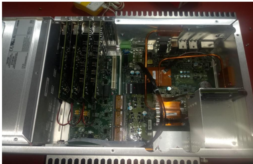
Figura 4. 2.- El Hardware del RTAC es básicamente una computadora
