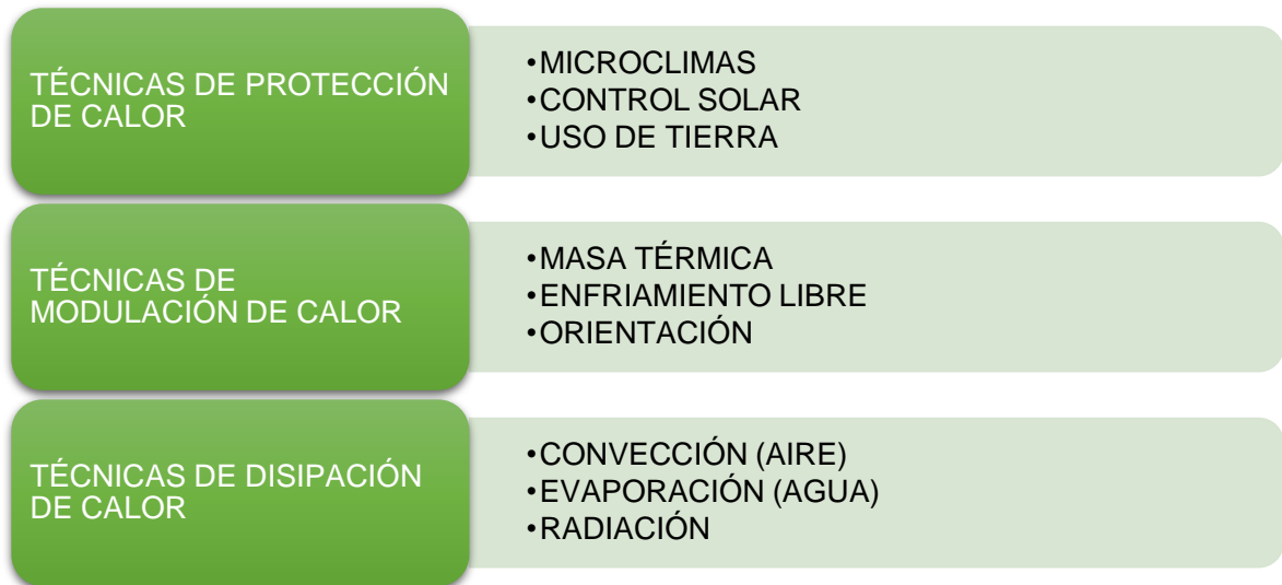
Figura 3.3. Técnicas Pasivas de Climatización
