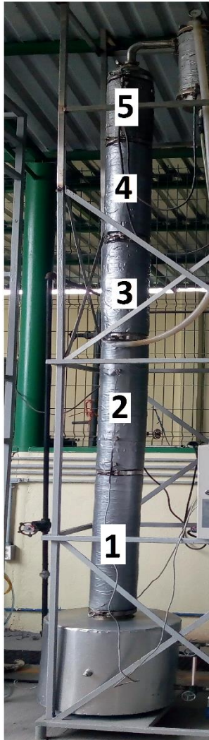
Figura 2.1 - columna de destilación. 1y 2 platos perforados inclinados, 3 y 4 tapas de burbuja grandes, 5 tapas de burbuja pequeñas
