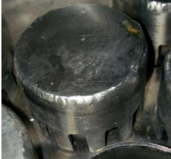
Figura 4.2 – Detalle de las ranuras en una tapa de burbuja de las secciones 3 y 4.
