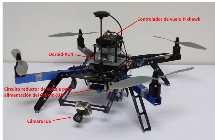
Figura 5.31: Odroid-XU4 y cámara IDS montados en el vehículo.
