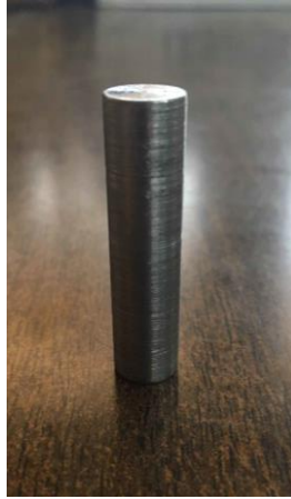
Figura 14.- Espécimen de Acero AISI-SAE 1045 maquinado en torno.
