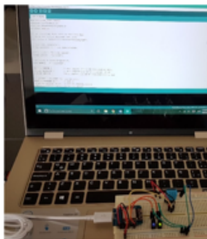
Figura 28: Cargando el programa al DI mini utilizando IDE de Arduino
