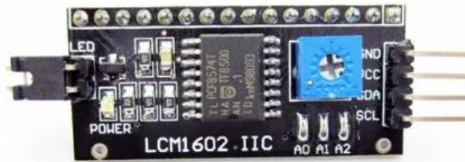
Figura 4.20: Conversor Paralelo a I2C para display LCD de 2 X 16
