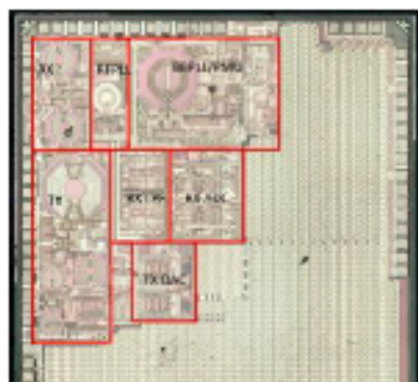
Figura 2: Interior de un ESP8266 con periféricos anotados.
