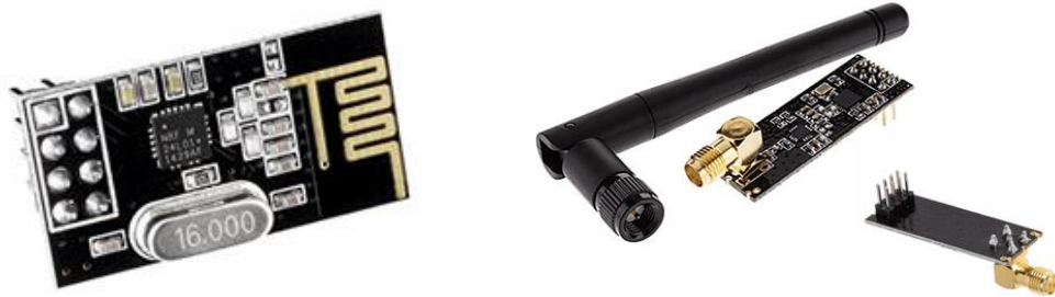
Figura 3.10: NRF24L01 en sus dos versiones con Antena Impresa y Externa.
