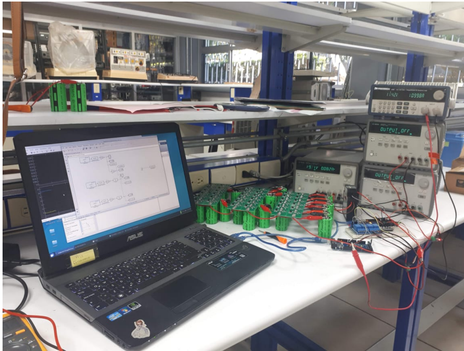
Figura 4.4: Banco de pruebas del banco de supercapacitores.
