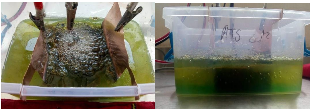
Figura 11. Celda electrolítica rectangular.
