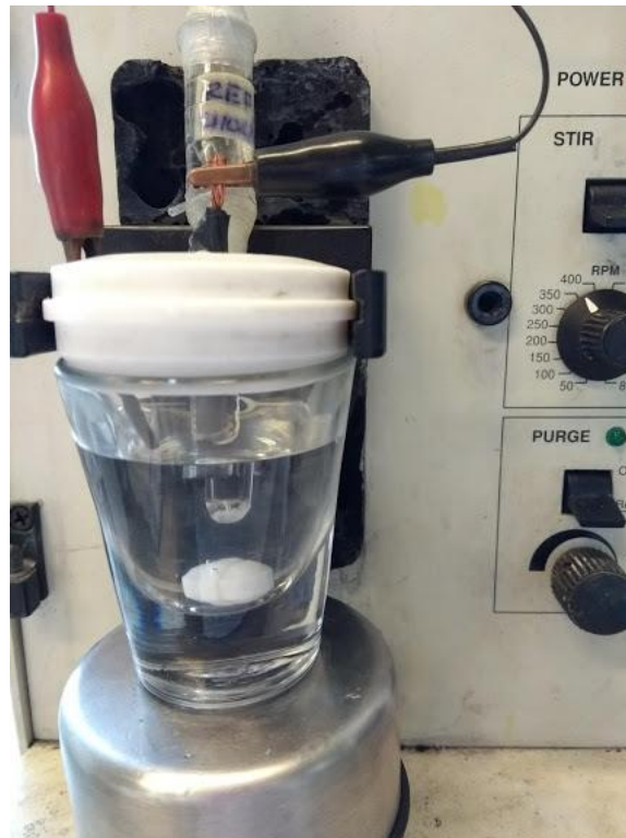
Figura 15. Celda de caracterización para realizar los voltamperogramas.
