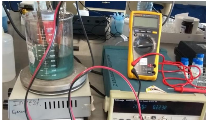
Figura 2. Diseño de una celda electrolítica.
