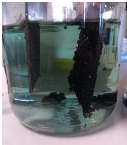
Figura 14. Tratamiento electroquímico al final. Condiciones: volumen de 500 mL de residuales líquidos de DQO, agitación= 500 rpm, electrodos Cu-Cu.
