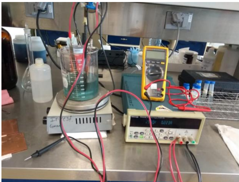
Figura 10. Celda electroquímica de tratamiento.
