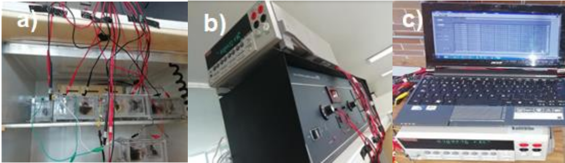
Figura 3.6 CCM conectadas al potencioestado Keithly 2000 y registro de los voltajes con el software LabVIEW
