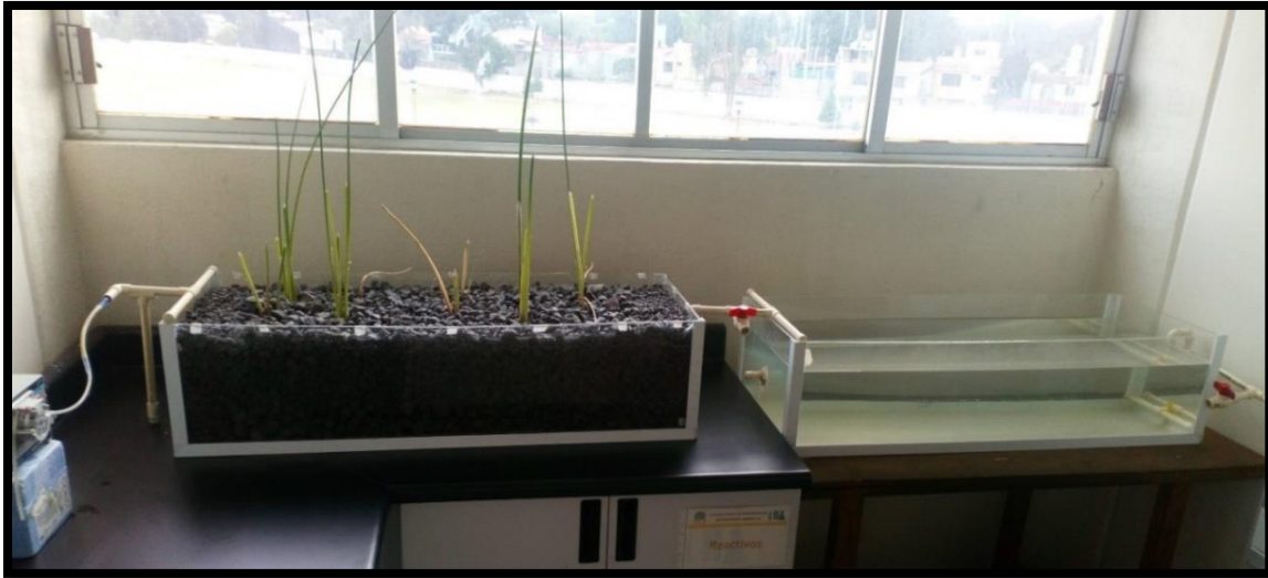
Figura 2.7. Construcción final del sistema de fitodepuración.
