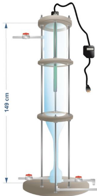
Figura 2.10. Esquema y estructura del reactor para el proceso de O_3 /UV.
