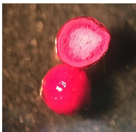
Figura 3.5 Imagen del hidrogel Q-TPP seccionado, liofilizado y sorbido
