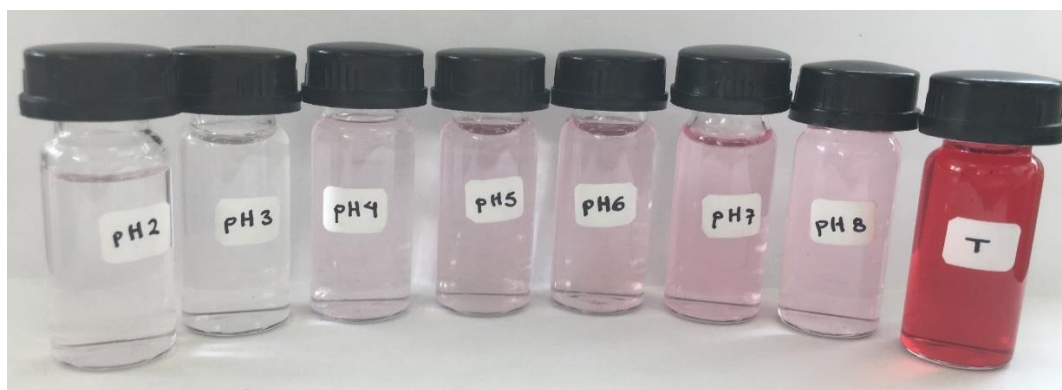
Figura 3.17 Soluciones residuales de la adsorción del colorante respecto al efecto de pH de la solución con el hidrogel Q-TPP IRR a 20V, 30min
