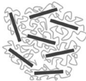
Figura 1.11. Estructura de un composito exfoliado (Hernández-Hernández et al. , 2018).
