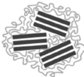
Figura 1.12. Estructura de un composito aglomerado (Hernández-Hernandez et al. , 2018).
