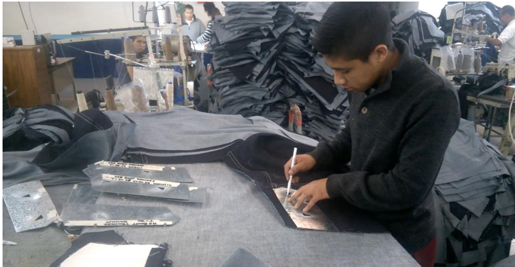
Figura 1 Operación de marcado de la bolsa trasera [Fuente Propia 2020].
