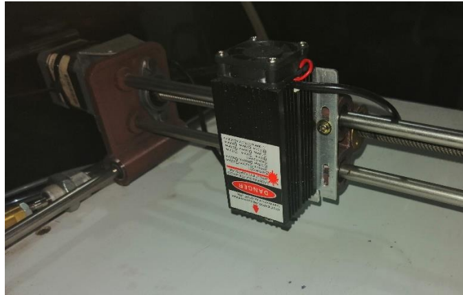
Figura 23 Láser para realizar las marcas montado en el robot cartesiano [Fuente propia 2020]
