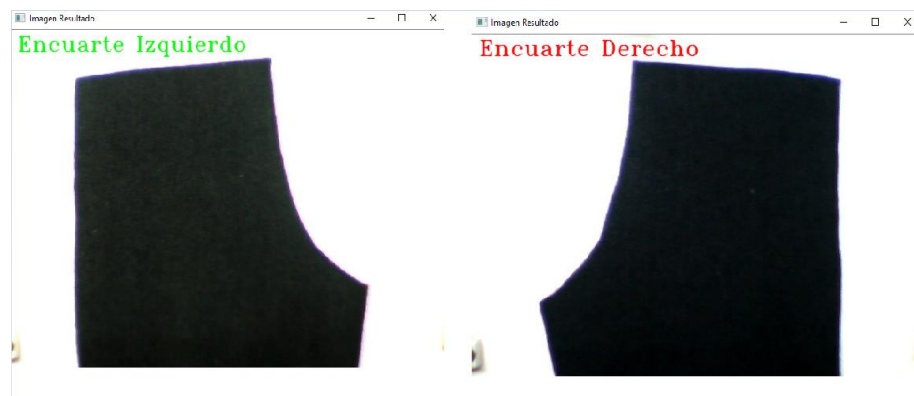
Figura 29 Encuertes identificados por el algoritmo [Fuente propia2020]
