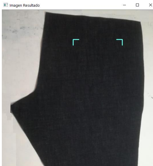
Figura 24 Muestra como resultado la forma y posición de las marcas que posteriormente se harán con el láser [Fuente propia 2020].
