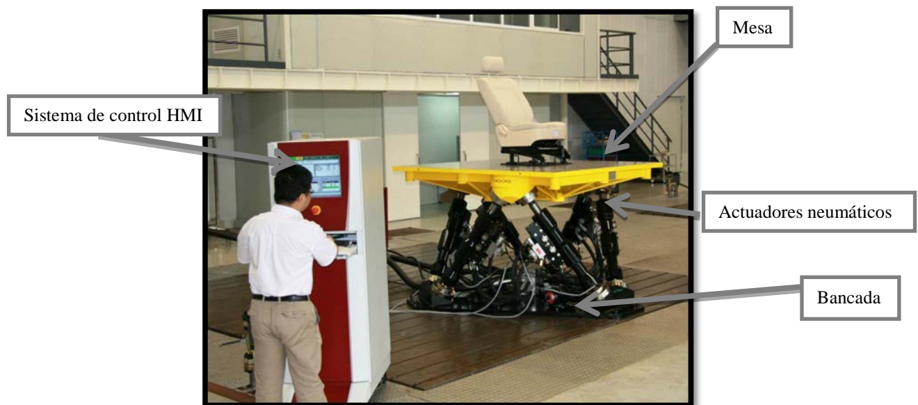
Figura 2. 3 Dispositivo implementado para ensayos con actuadores neumáticos
