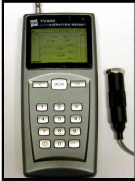
Figura 3. 31 Vibrometro portable TV300, implementado para medición de vibraciones
