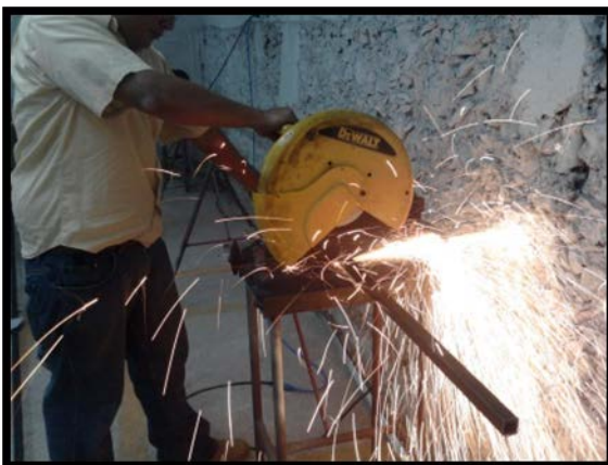
Figura 4. 19 Corte con disco del perfil PTR Figura 4. 20 Soldadura del marco estructural
