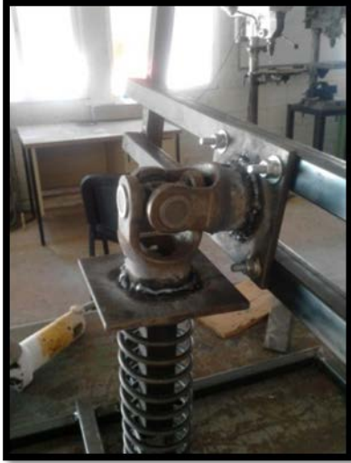
Figura 4. 27 Instalación de cruceta en Yugo Figura 4. 28 Ensamble de levas en flechas
