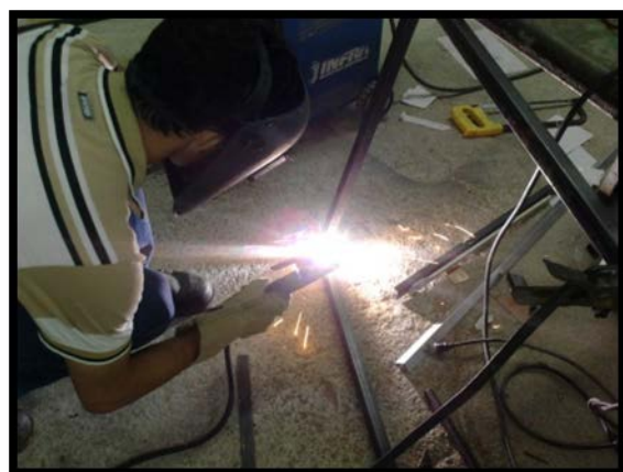
Figura 4. 19 Corte con disco del perfil PTR Figura 4. 20 Soldadura del marco estructural
