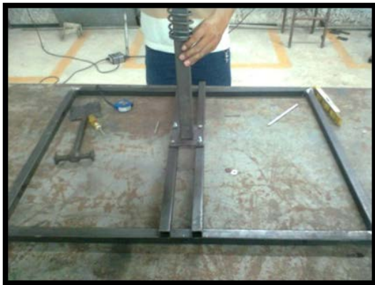
Figura 4. 23 Montaje del resorte en base
