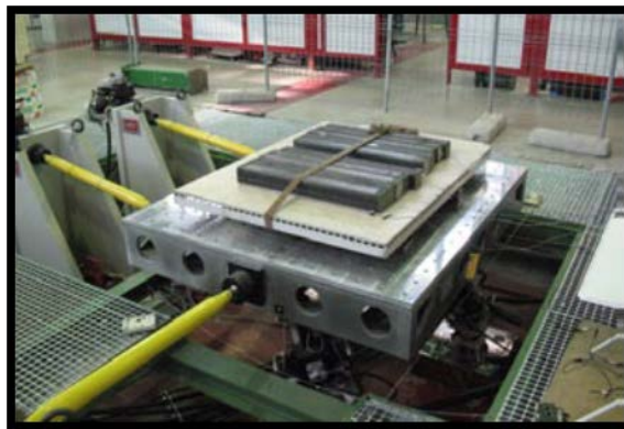
Figura 3. 4 Dispositivo MAST implementado para ensayo de comp. Electrónicos (3)
