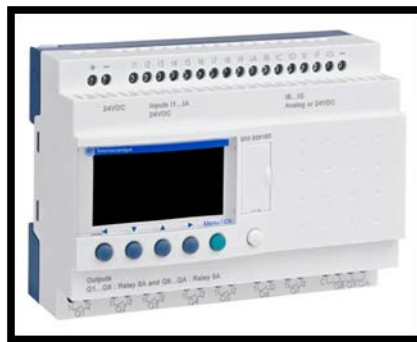
Figura 4. 14 Relevador Inteligente Zelio SR3B261BD
