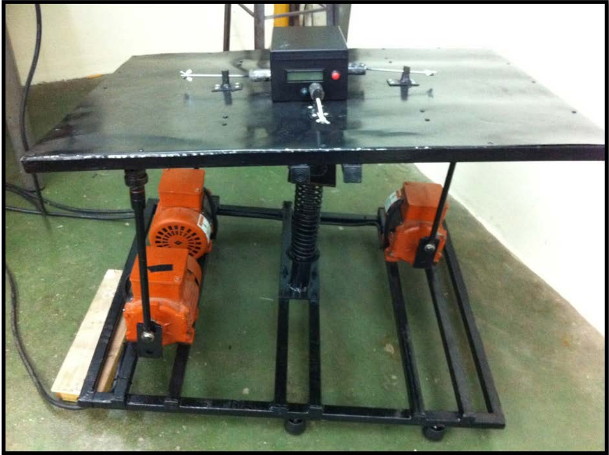
Figura 4. 35 Ensayo de durabilidad realizado a dispositivo de comunicación marítimo
