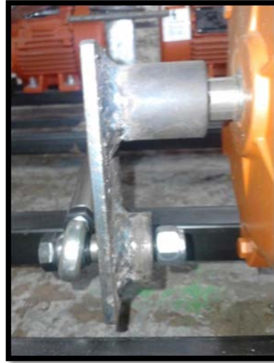
Figura 4. 27 Instalación de cruceta en Yugo Figura 4. 28 Ensamble de levas en flechas
