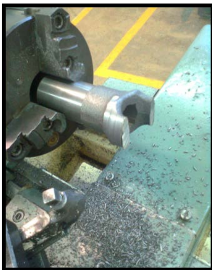
Figura 4. 25 Torneado de soporte de resorte
