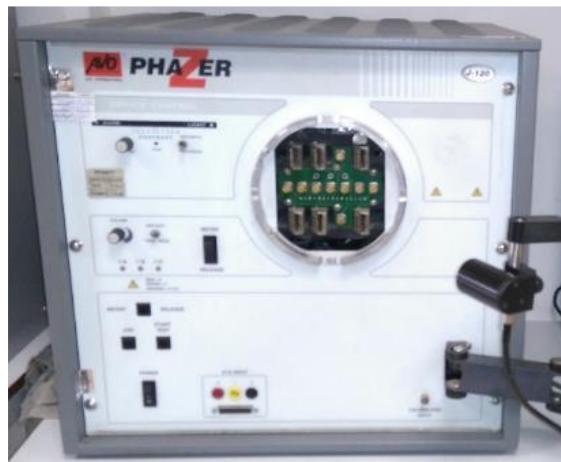
Figura 3. Sistema de calibración para laboratorio marca Phazer modelo J-120 [7].
