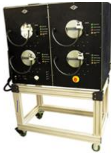
Figura 2. Mesa de calibración medidores multi posición marca TESCO [6].
