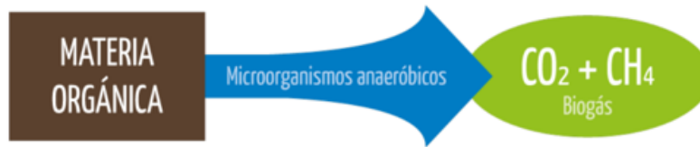
Fig. B.1.1. Proceso de digestión anaerobia
