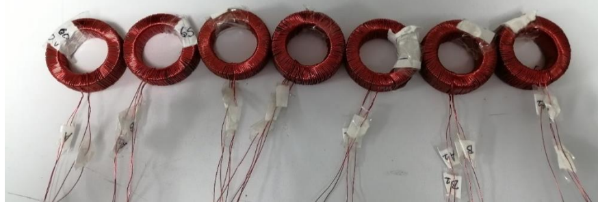
Figura 25. Núcleos elaborados con el material hierro/resina con el mismo número de vueltas.
