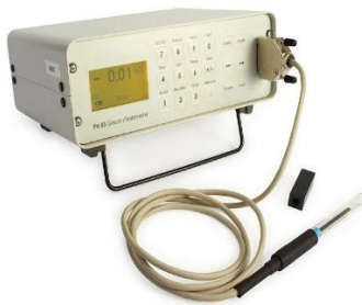
Figura 10. Gaussímetro para mediciones de densidad de flujo magnético [16].
