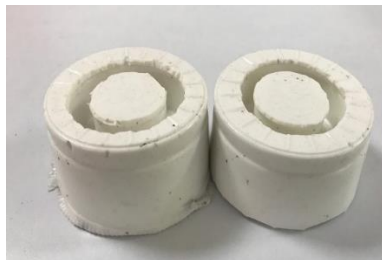
Figura 16. Molde de silicona de un núcleo de ferrita convencional.
