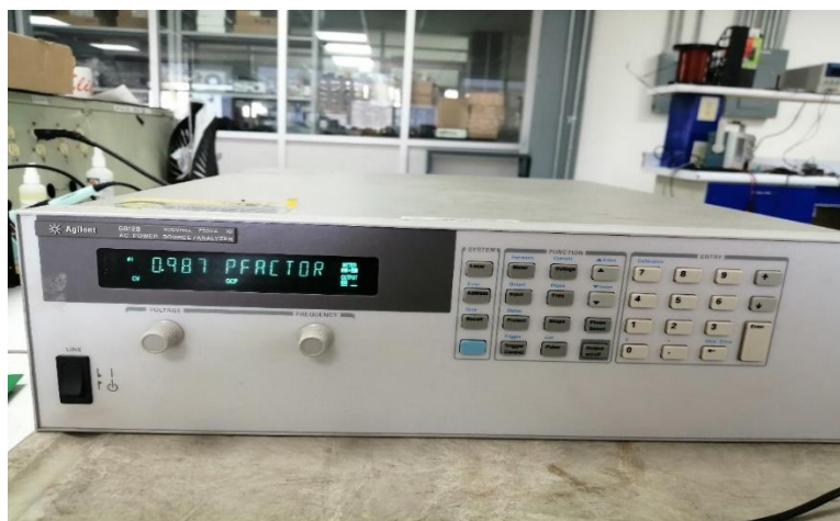
Figura 46. Factor de potencia alcanzado, con el convertidor resonante LC serie.
