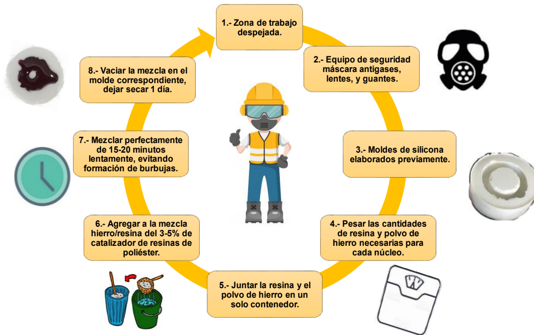
Figura 17. Metodología empleada para la elaboración de los núcleos compuestos de resina y polvo de hierro.
