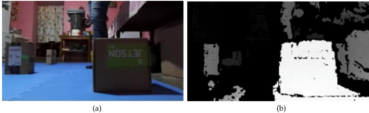
Figura 4.12: Campo de visión del robot con un obstáculo por la región derecha del robot, la distancia al objeto es de z : 34.4736cm .
