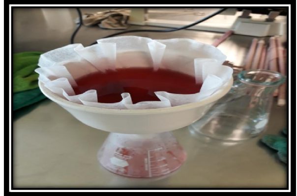
Figura 26. Filtración de la muestra para determinación de fibra cruda.
