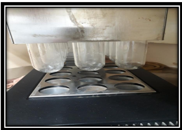
Figura 7. Digestión para la determinación de Fósforo, Hierro, Zinc, Calcio, Potasio y Magnesio.
