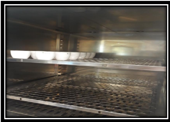
Figura 15. Crisoles puestos a peso constante para la determinación de cenizas.
