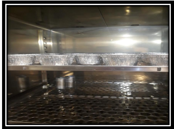
Figura 2. Secado del frijol verdín en la estufa a una temperatura de 70°C durante 24 horas.
