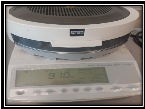
Figura 11. Determinación de humedad del frijol verdín.
