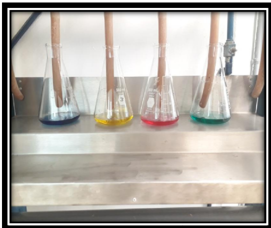
Figura 21. Cambio de vire de la destilación de proteína de frijol verdín.
