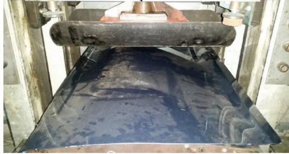
Figura 6.4. Prueba experimental de impacto dinámico en puerta de vehículo, [Long et al. , 2019].
