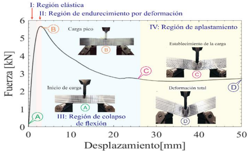
Figura 3.3. Etapas y zonas de trabajo de perfil a flexión de tres puntos.
