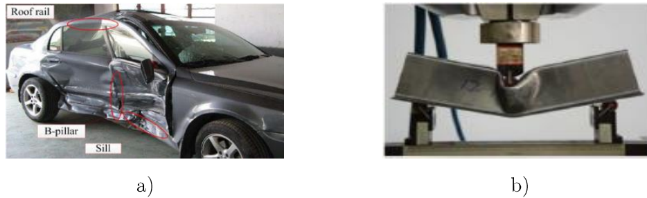
Figura 2.13. Análisis de impactos laterales donde: a) Impacto lateral en perfiles TRB, b) Prueba de 3 puntos en perfil TRB, [H. Zhang et al. , 2018].
