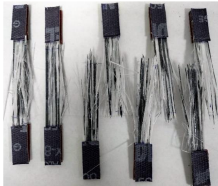
Figura 5.5 Modos de falla en las probetas del laminado Ac [G/C/G]s.
