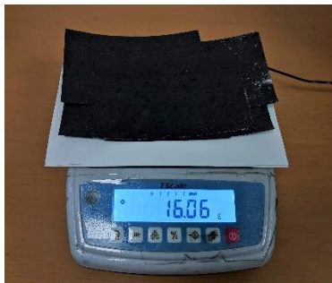
Figura A.2 Balanza digital T-SCALE®, precisión de 0.02 gramos.
