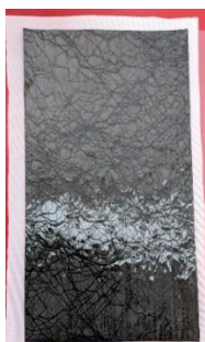
Figura A.1 Lámina de fibra unidireccional “Uni-Web unidirectional carbon fiber”.
