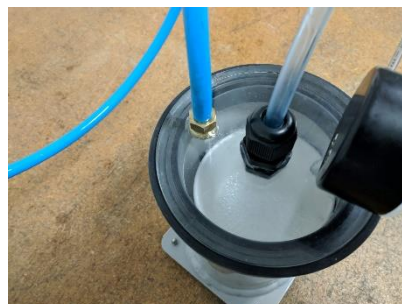
Figura A.5 Extracción del aire atrapado en la mezcla de resina y endurecedor Epolam 5015/5015.
