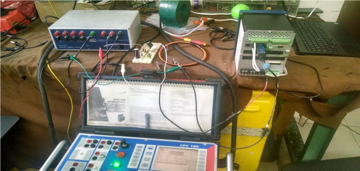
Figura 3.27. Pruebas de Bobina Rogowski con equipo CPC-100.
