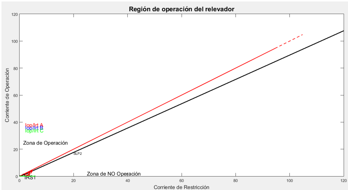
Figura 4.74. Comportamiento de las Corrientes de Operación y Restricción con falla Monofásica Interna.
