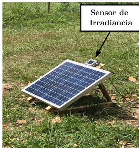
**Figura 5.1:** Panel PV PROSE-5012 expuesto a condiciones exteriores.
