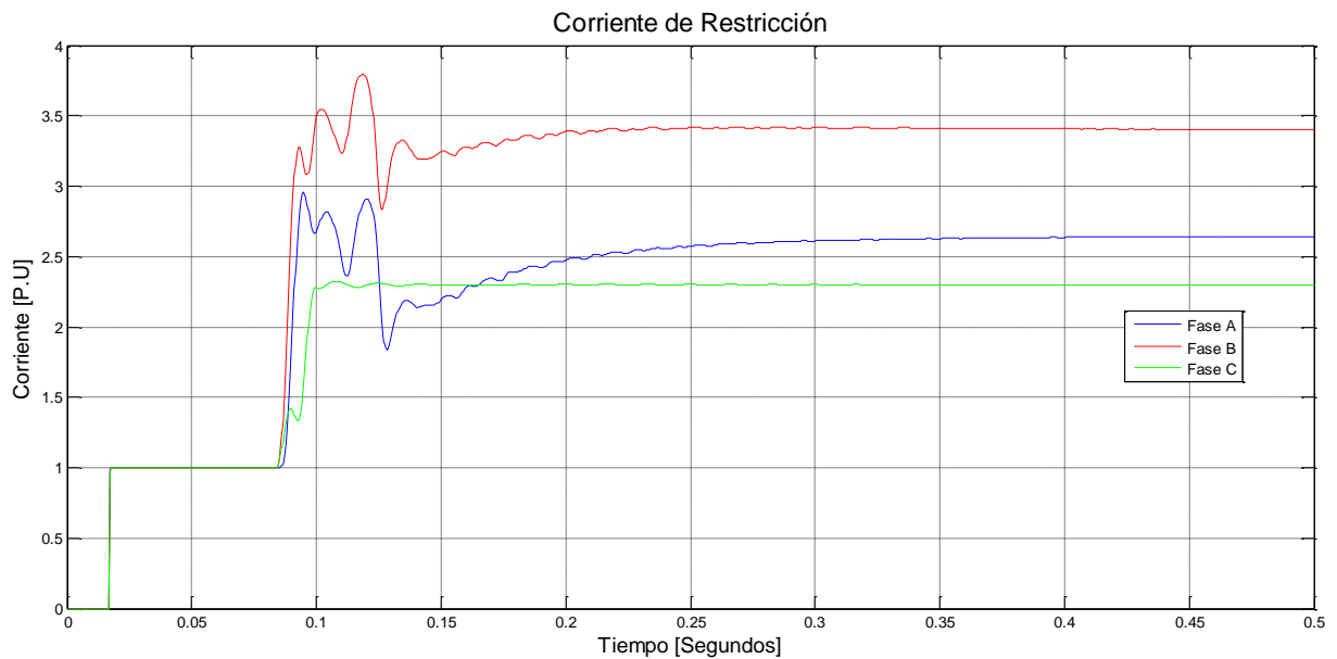
Figura 4.75. Oscilograma de la corriente de restricción con falla bifásica a tierra externa en 400 kV.
