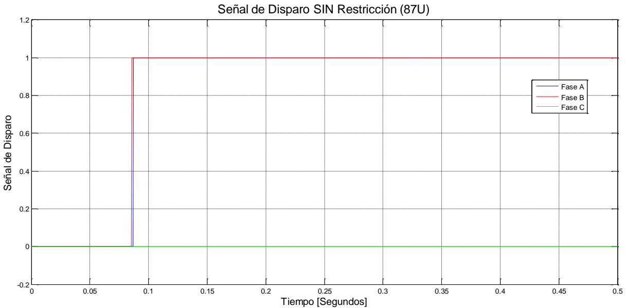
Figura 5.73. Señal de Disparo SIN Restricción (87U) y con falla Bifásica a tierra interna en el devanado de 115 kV.
