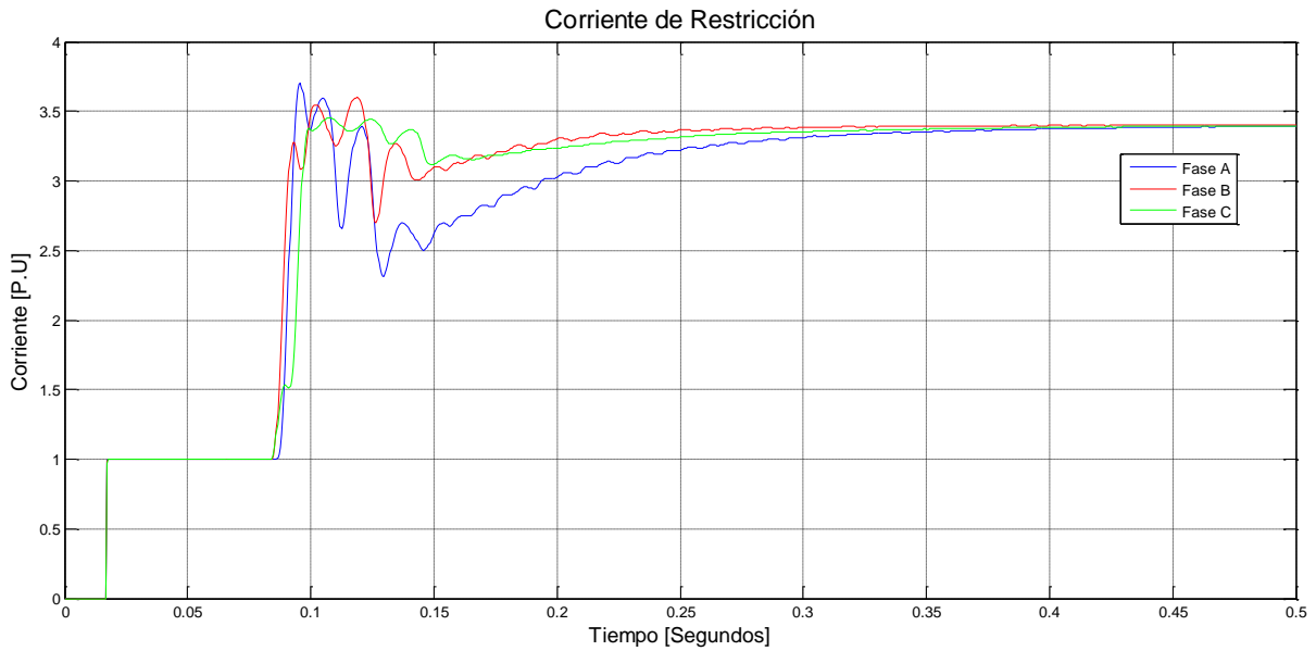
Figura 4.83. Oscilograma de la corriente de restricción con falla trifásica a tierra externa en 400 kV.
