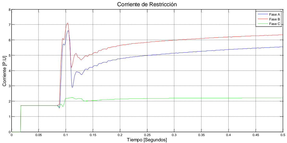
Figura 4.102. Oscilograma de la corriente de restricción con falla Bifásica a tierra interna en el devanado de 20 kV.
