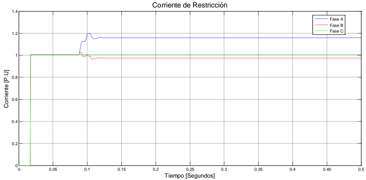
Figura 6.27. Oscilograma de la corriente de restricción con falla monofásica a tierra al 50% del Devanado.
