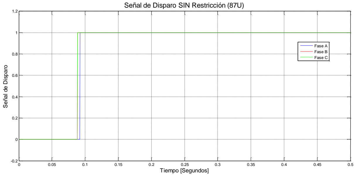
Figura 4.123. Señal de Disparo SIN Restricción (87U) y con falla Trifásica a tierra interna en el devanado de 400 kV.
