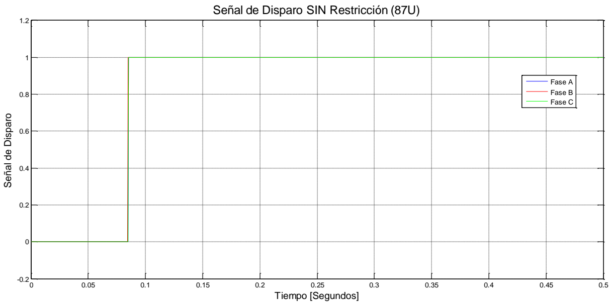
Figura 5.80. Señal de Disparo SIN Restricción (87U) con falla Bifásica a tierra interna en el devanado de 13.8 kV.
