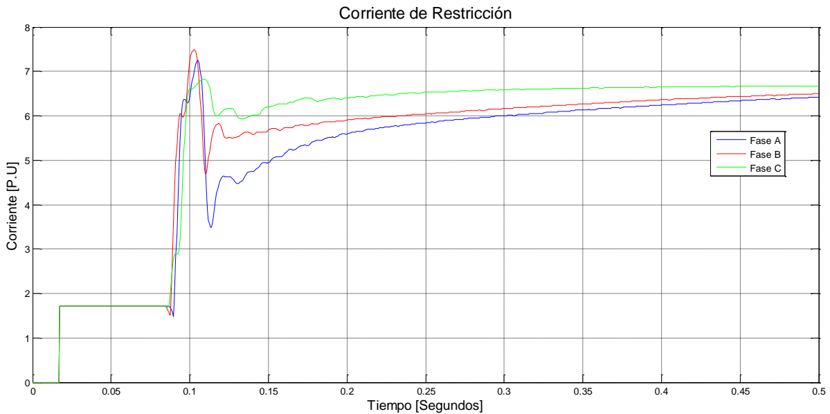
Figura 4.115. Oscilograma de la corriente de restricción con falla Trifásica a tierra interna en el devanado de 20 kV.
