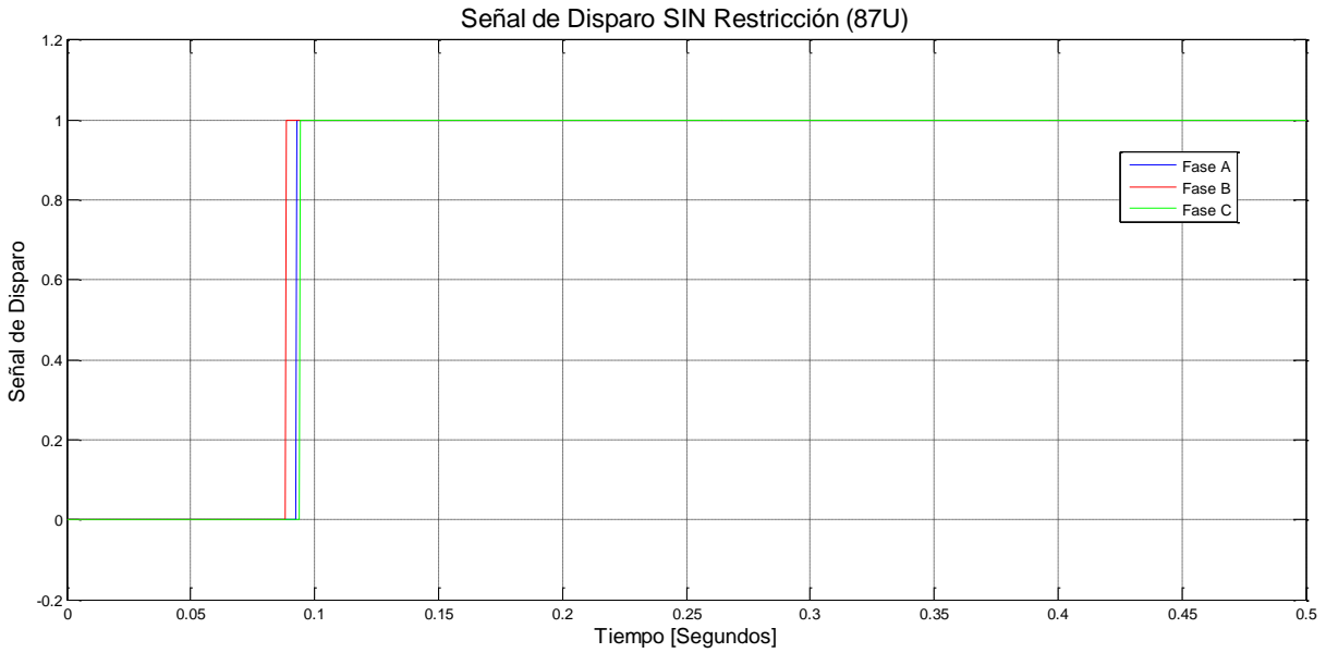
Figura 4.110. Señal de Disparo SIN Restricción (87U) y con falla Bifásica a tierra interna en el devanado de 400 kV.
