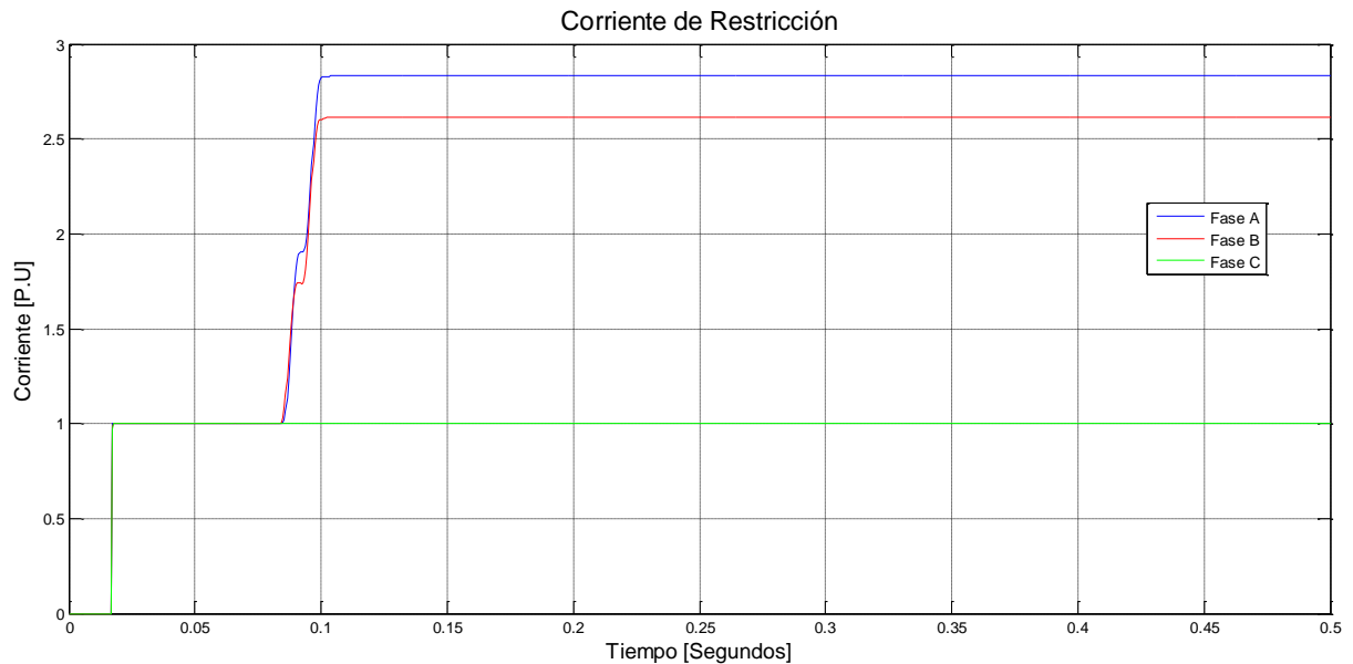
Figura 5.36. Oscilograma de la corriente de restricción con falla monofásica a tierra externa en 13.8 kV.
