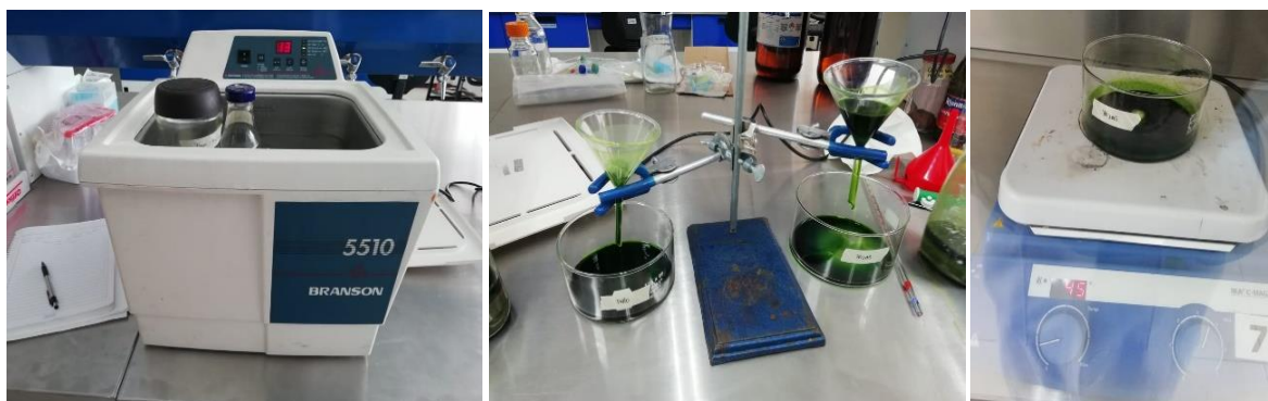
Figura 8. Obtención de extractos etanólicos mediante maceración asistida por ultrasonido.
