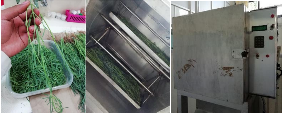
Figura 6. Secado de pipicha utilizando un secador de charolas giratorias.
