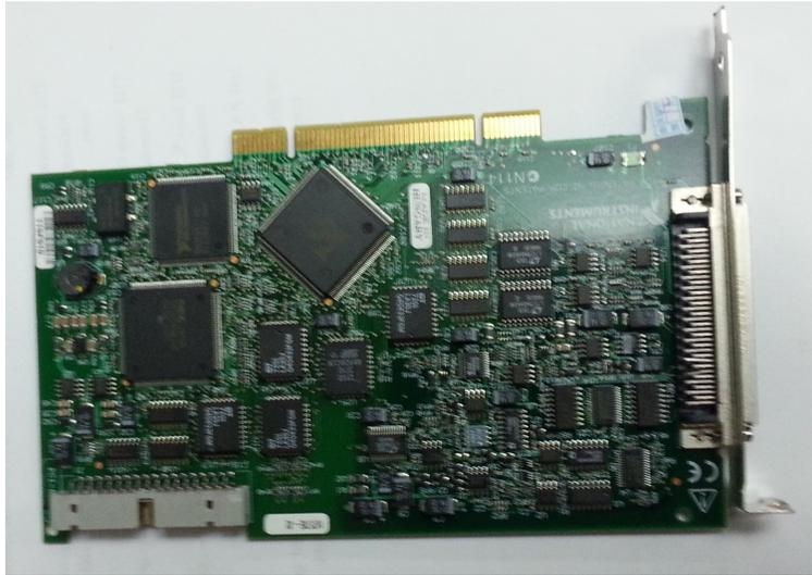
Figura 4.2: Tarjeta de adquisición de datos NI PCI-6024E
