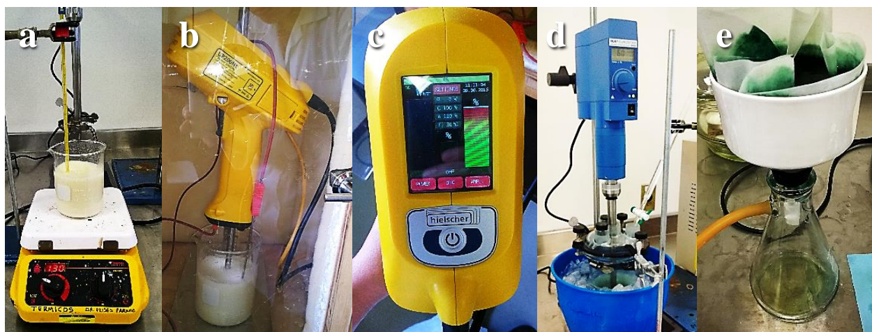
Figura 2.4. Procedimiento de síntesis de los precursores PANi/OMMT
