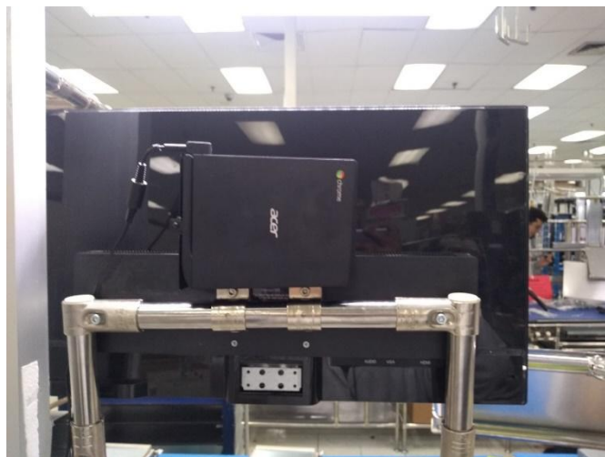
Figura 23. Chromebox atornillada a monitor.
