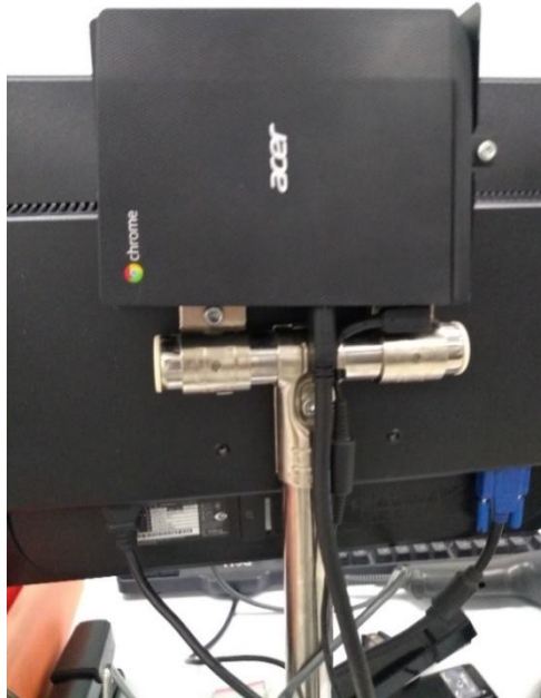
Figura 24. Conexión de HDMI, mouse, teclado y cable de alimentación a Chromebox . Fuente Fuente área de IT Soporte de equipo de cómputo.
