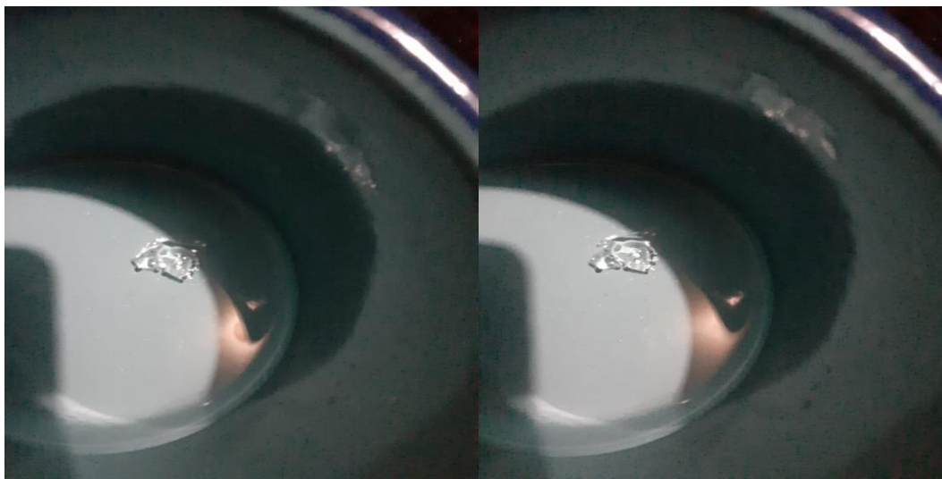
Imagen 4. Biofilm en prueba de resistencia y solubilidad a una temperatura de 30°C
